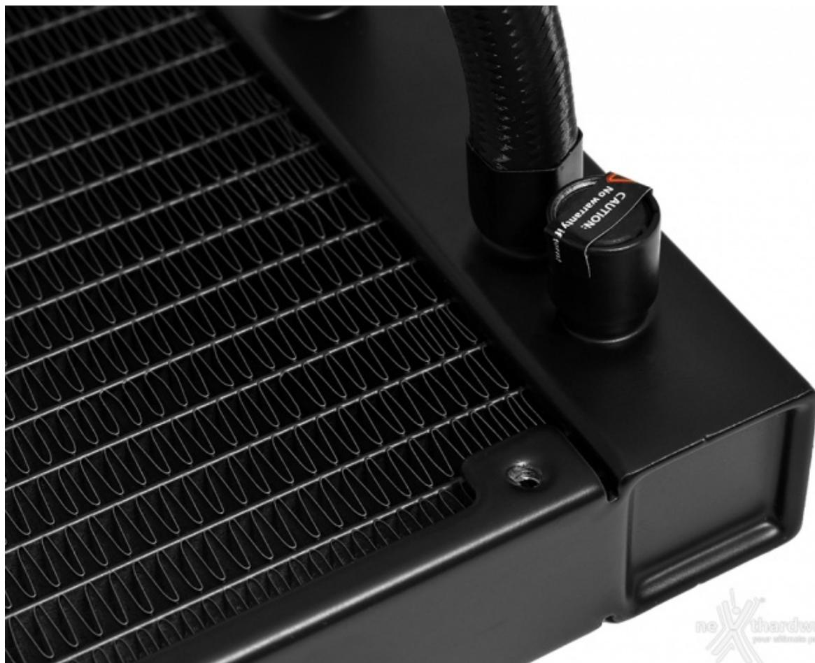
La lunghezza del radiatore, leggermente più elevata rispetto ad altri AIO da 280mm, è dovuta all'integrazione della tecnologia Anti-Leak che comporta la presenza di una valvola per la fuoriuscita dell'aria in eccesso, protetta da un sigillo che vi invitiamo a non rimuovere per non invalidare la garanzia.
