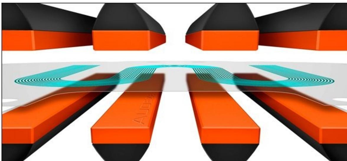
Mentre nei driver dinamici convenzionali il diaframma è collegato direttamente ad una bobina mobile che lo fa vibrare, nelle soluzioni di tipo planare il diaframma è costituito da un film sottile immerso in un campo magnetico ed è intrecciato con dei sottilissimi conduttori elettrici.
