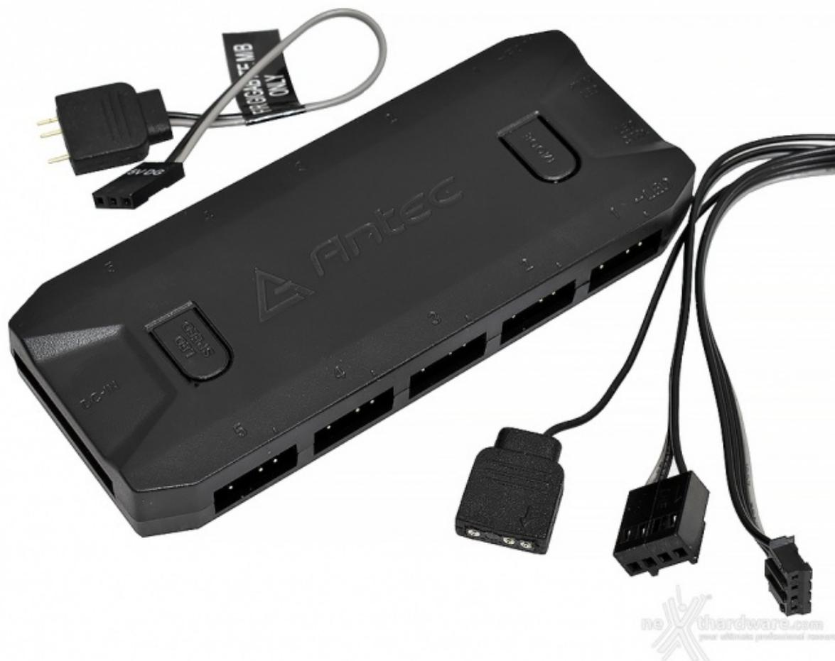
Il pezzo forte del bundle è sicuramente il controller a cinque ingressi, dotato anche di una porta di output per collegare in cascata ulteriori dispositivi.
