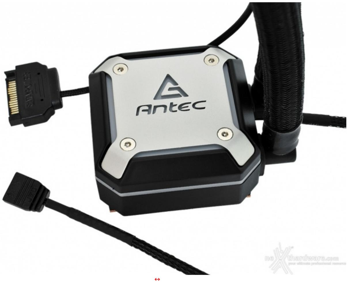
Come detto in precedenza, la cavetteria in uscita dal sistema di dissipazione consta di due soli connettori.
