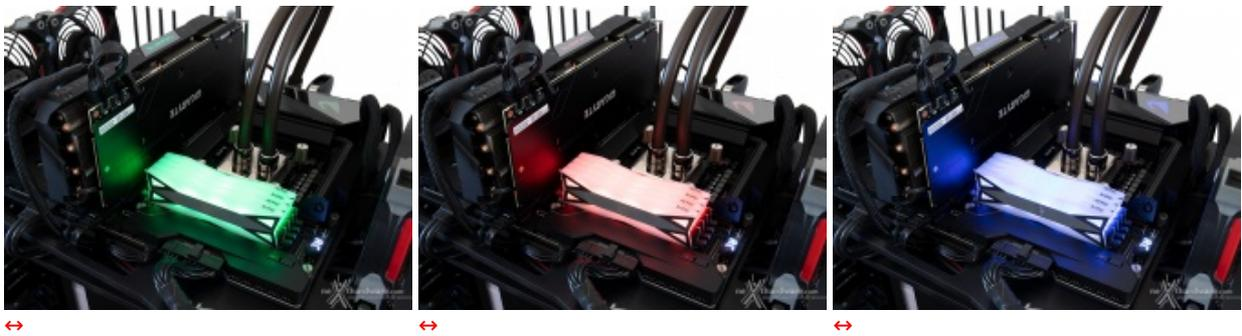
La GIGABYTE Z490 AORUS XTREME utilizza, ovviamente, il sofisticato sistema di illuminazione multizona RGB Fusion, decisamente meno invasivo rispetto ai modelli di precedente generazione comprendendo, di fatto, soltanto due zone, ovvero il carter che sormonta il back panel ed il dissipatore sul chipset.
