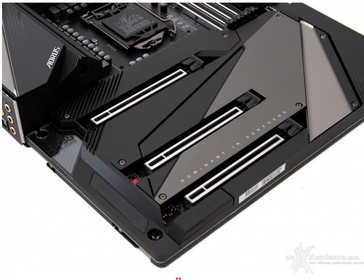
L'immagine in alto ci mostra la dotazione di slot PCI Express comprendente tre PCIe 3.0 x16 funzionanti, rispettivamente, in modalità x16, x8 e x4.
