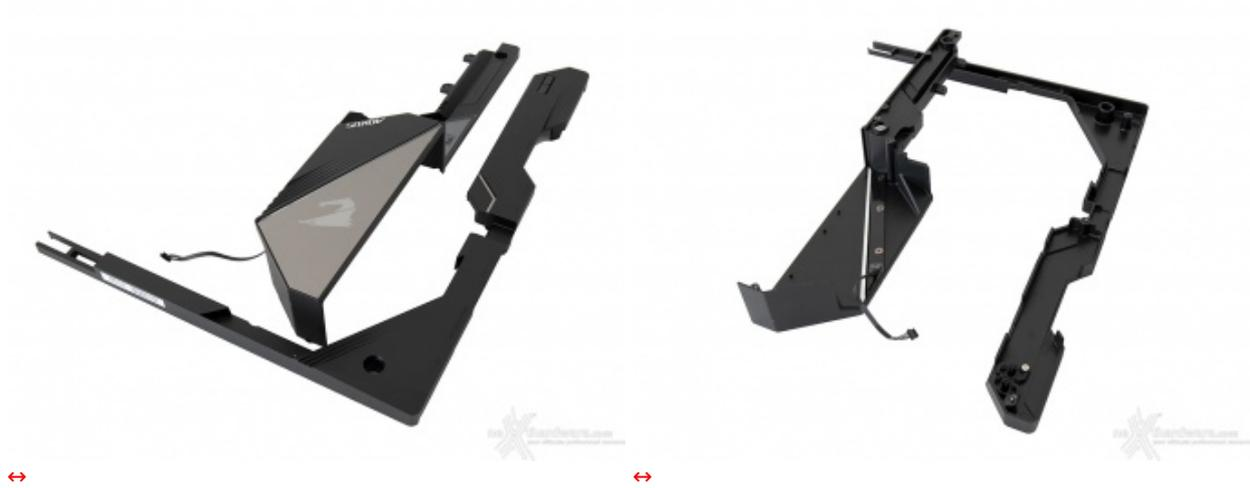
In alto possiamo osservare i componenti superiori del Thermal Reactive Armor che, oltre ai dissipatori già visti, comprende una serie di cover in plastica e alluminio con finalità puramente estetiche.
