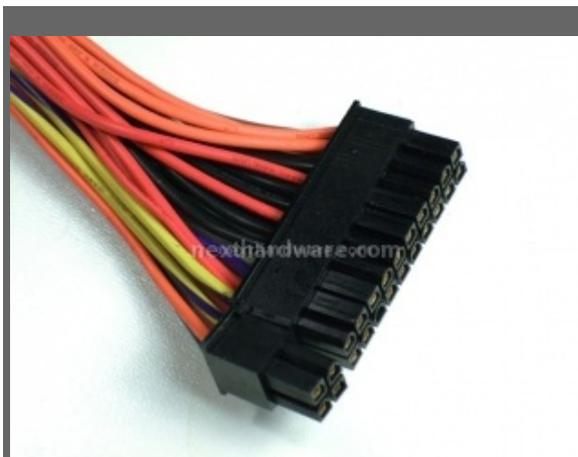
Cavo di alimentazione ATX 24pin
