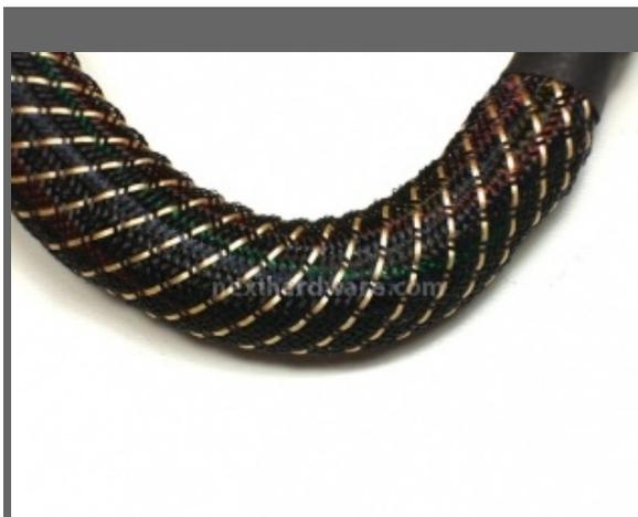
Stesso tipo di maglia utilizzato per tutti i cablaggi, buona la scelta di usare lo sleaving multifilo anche per i cavi meno importanti. Notare come per questo modello venga usato lo stesso tipo di rivestimento che potete trovare anche negli alimentatori Enermax.
