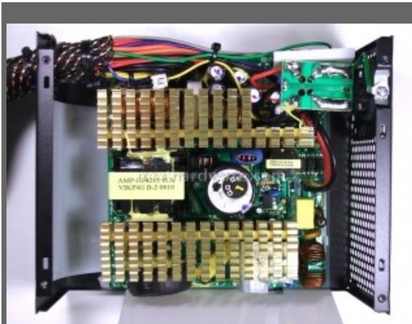
Simile al design dei dissipatori utilizzati da Enhance per gli alimentatori CoolerMaster il profilo del corpo dissipante del EzCool.
