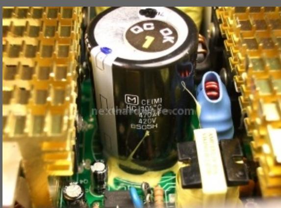
Come filtraggio delle correnti in ingresso troviamo un imponente condensatore [Matsushita](http://www.panasonic-electric-works.it/pewit/it/html/index.php) (<http://www.panasonic-electric-works.it/pewit/it/html/index.php>).
