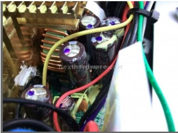
Per la sezione di condensatori dedicati alla corrente in uscita troviamo dei JP ce-tul, stesso brand impiegato in alcuni alimentatori Enermax.
