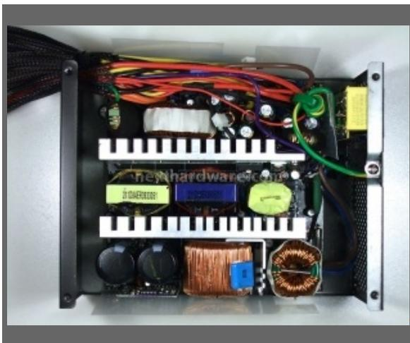
Da questa foto si riescono bene ad intuire le dimensioni imponenti dei toroidi utilizzati per filtrare le correnti in ingresso e in uscita.
