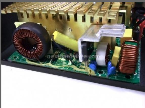
Decisamente spartana questa parte dell'alimentatore, toroidi di dimensioni molto contenute e decisamente poco professionale il dissipatore del singolo rettificatore di corrente, che non e' ancorato da nessuna parte.
