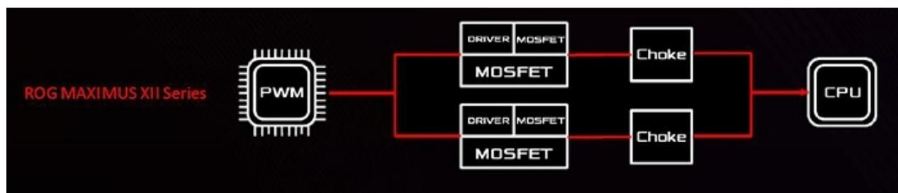
Il maggior numero di core rispetto alle precedenti generazioni di CPU e la loro capacità di passare da uno stato di carico all'altro molto più rapidamente ha comportato una rivalutazione delle priorità di progettazione che ASUS ha concretizzato abbandonando i duplicatori di fase (doubler) per passare ad un design Teamed, in cui la risposta della sezione di alimentazione non fosse ostacolata dal ritardo di elaborazione degli stessi.
