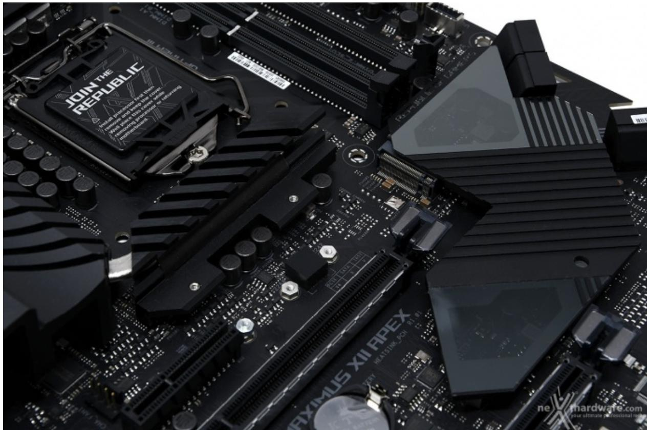
Grazie al supporto del nuovo chipset Intel Z490, la ASUS ROG MAXIMUS XII APEX è in grado di offrire un ulteriore slot M.2. senza utilizzare alcun controller di terze parti.
