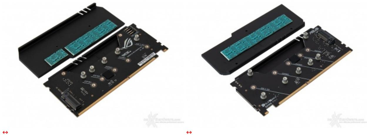
Nella dotazione accessoria della MAXIMUS XII APEX troviamo il ROG DIMM.2 Adapter, progettato per alloggiare due SSD M.2 (con lunghezza da 42 a 110 mm) il cui socket, come visibile nell'immagine sottostante, si trova accanto agli slot DIMM DDR4.
