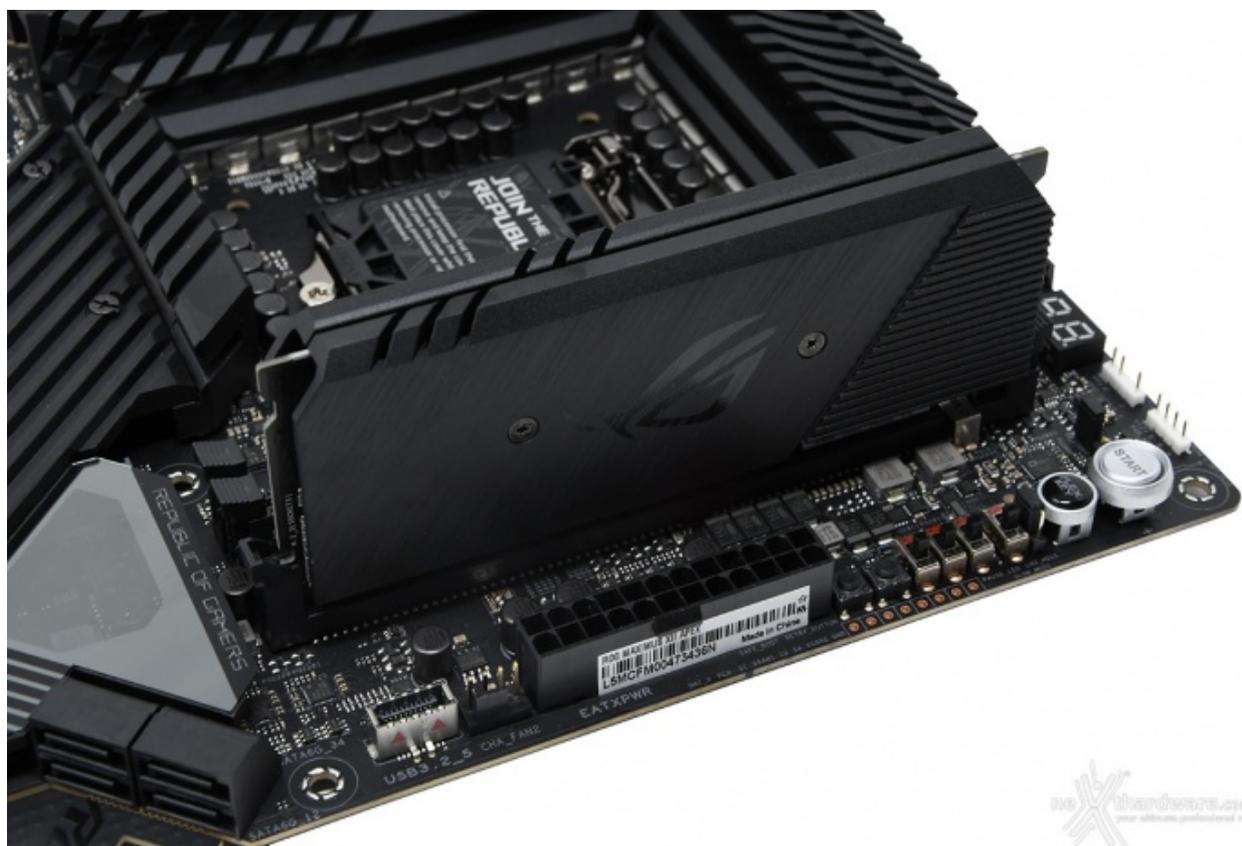
Il ROG DIMM.2 Adapter è dotato di un elegante dissipatore in alluminio nero con finitura satinata, che va ad interfacciarsi con i drive tramite efficienti pad termici di produzione Laird.
