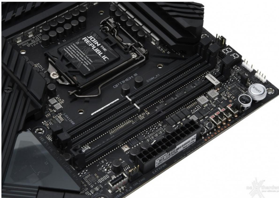
Il comparto dedicato alle memorie presenta due slot DIMM di colore nero, in grado di ospitare 64GB di DDR4 con frequenze fino a 5000MHz (OC), ovvero sino a due moduli da 32GB l'uno (in modalità dual channel) dotati di profili Intel XMP 2.0 per la configurazione automatica dei relativi parametri di funzionamento.
