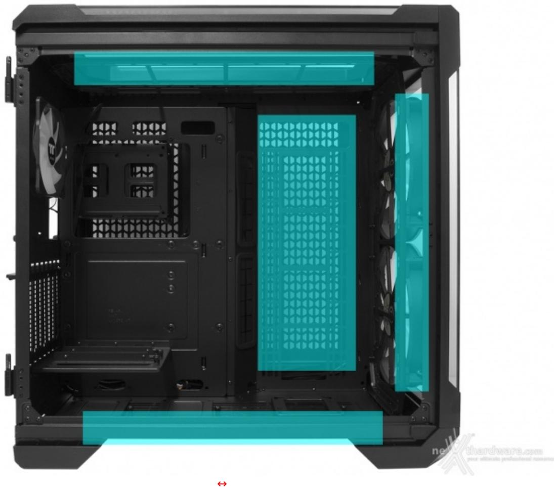
Tutte le predisposizioni sono utilizzabili per sistemi di raffreddamento a liquido custom e consentono l'utilizzo di un radiatore da 360 o 420mm sul frontale, sul top e a destra del piatto mainboard, uno da 360mm sul fondo e uno da 120mm sul retro.
