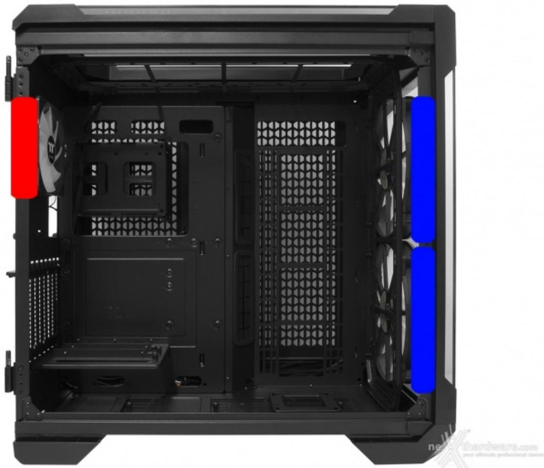
Anche in configurazione standard il case offre ottime prestazioni termiche grazie alla presenza di ben due ventole da 200mm posizionate frontalmente ed una da 120mm, in estrazione, sul retro.
