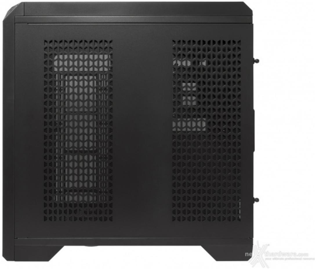
La destra, invece, è in metallo abbastanza flessibile a causa di due ampie griglie d'aerazione comprensive di filtri antipolvere calamitati montati internamente.
