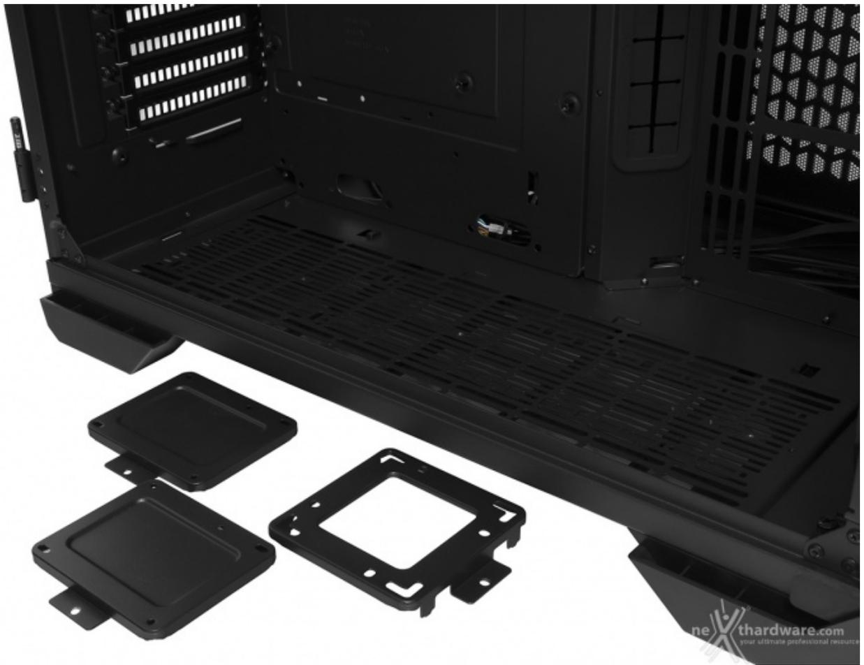
Sul fondo sono posizionati due supporti per drive da 2,5" ed uno per pompe; tutti e tre potranno essere spostati di qualche centimetro o rimossi del tutto, permettendo l'installazione di tre ventole da 120mm.
