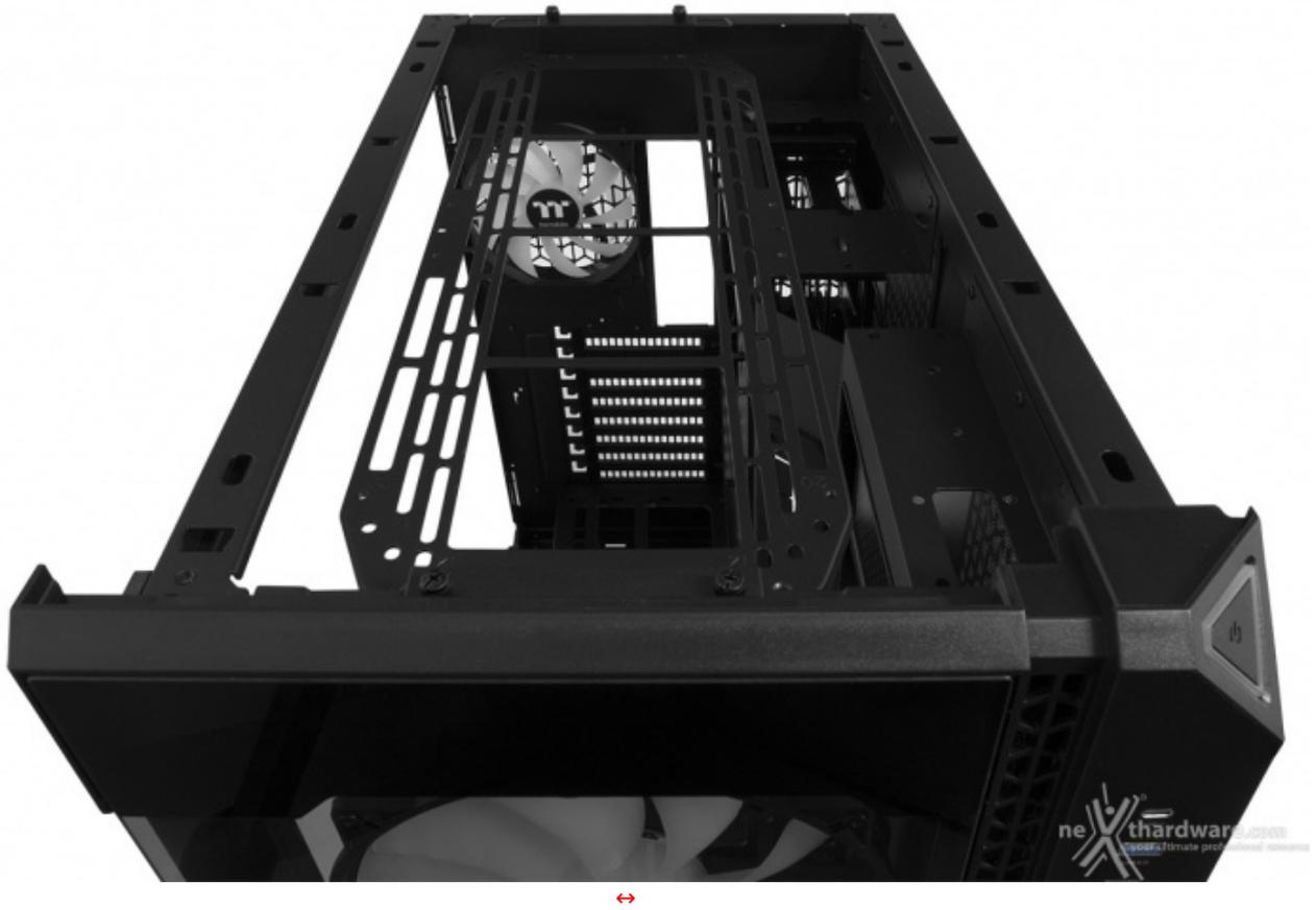
Il top del View 51 riprende le forme del frontale e, come quest'ultimo, è composto da un pannello in vetro temperato spesso 4mm distanziato dal telaio, di circa 10mm, per permettere la fuoriuscita dell'aria calda.
