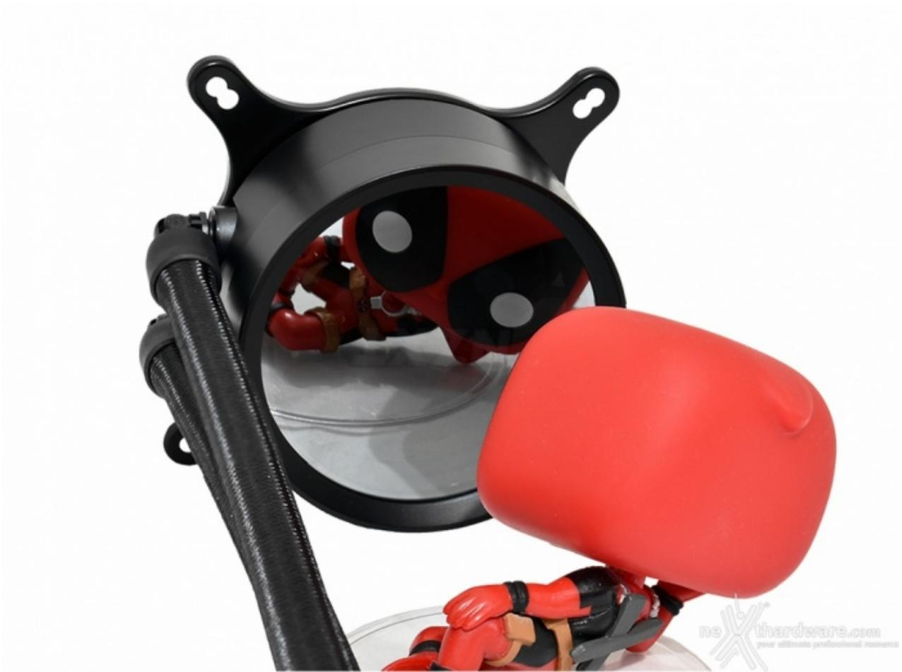
La parte superiore del blocco pompa/waterblock è interamente realizzato in vetro e, rispetto alla generazione precedente di Kraken, la superficie è aumentata del 10%.
