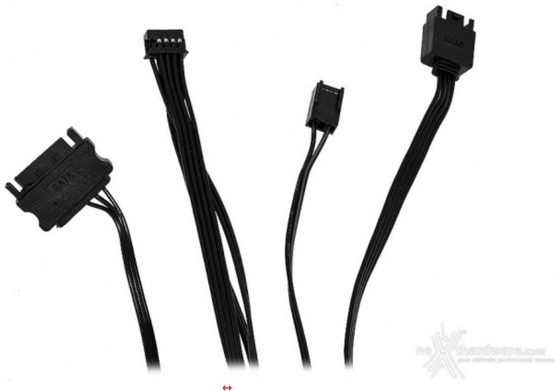
Il cavo principale ha quattro diverse estremità : da un parte troviamo il connettore proprietario NZXT da collegare alla pompa e, dall'altra, abbiamo un connettore SATA POWER per garantire i 12V necessari al corretto funzionamento dell'unità , un classico 3 pin tachimetrico da inserire su uno degli header CPU FAN della scheda madre, ed uno speciale connettore a 4 pin per interfacciare un dispositivo HUE, se presente.
