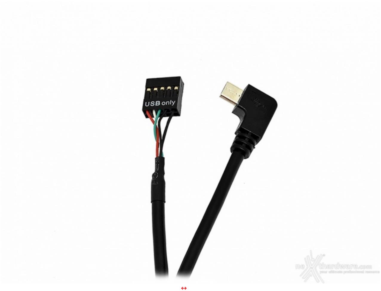
Infine, in bundle, troviamo un cavo Micro-USB di tipo B per collegare la pompa direttamente alla scheda madre tramite un connettore USB 2.0 che servirà per interfacciarsi con il software di gestione iCUE.
