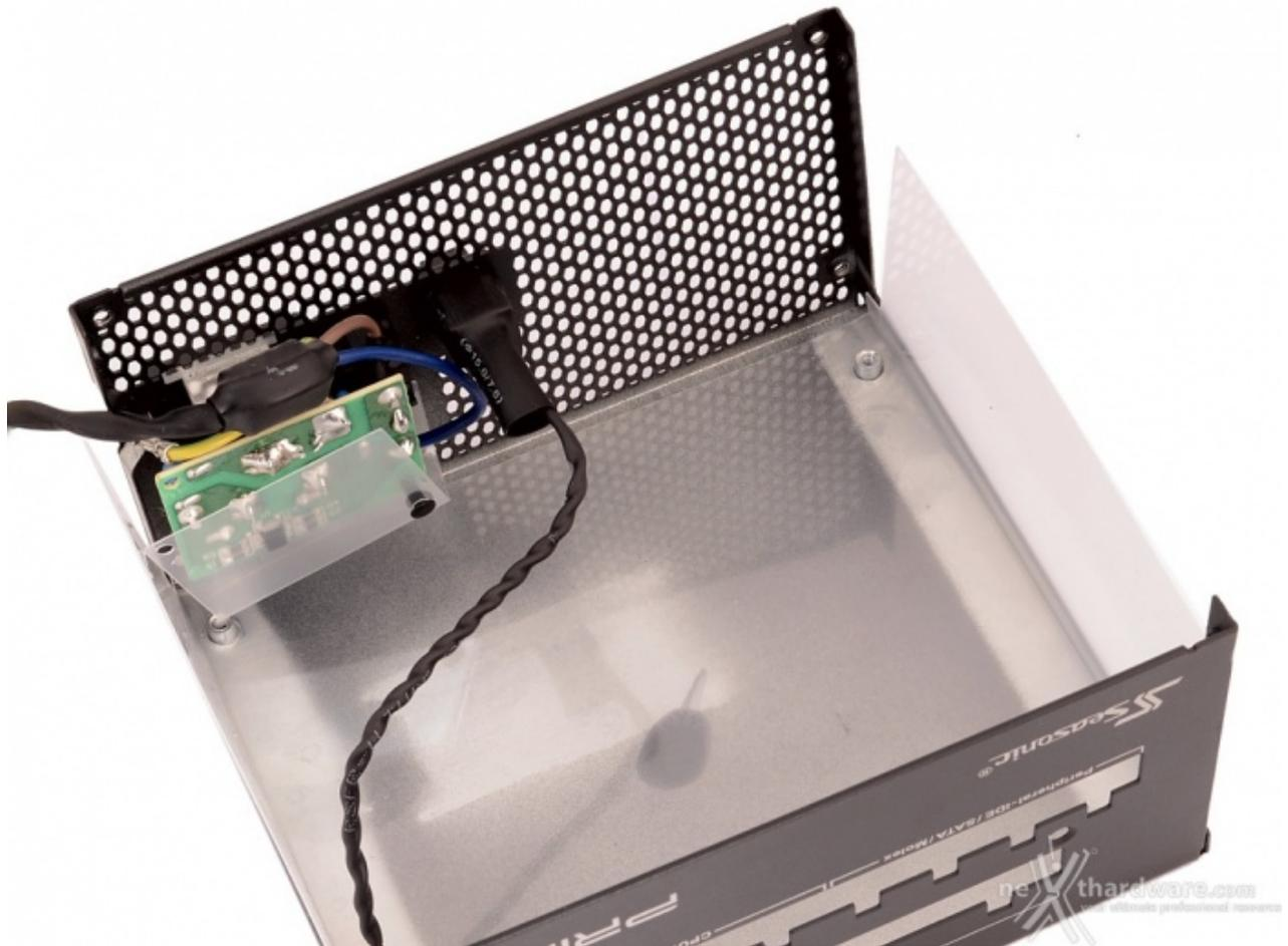
Rimosso il PCB dalla parte inferiore dello chassis abbiamo modo di osservare una parte del filtro EMI, ospitato su un piccolo PCB ancorato sul retro del blocco presa/interruttore (privo della schermatura metallica).
