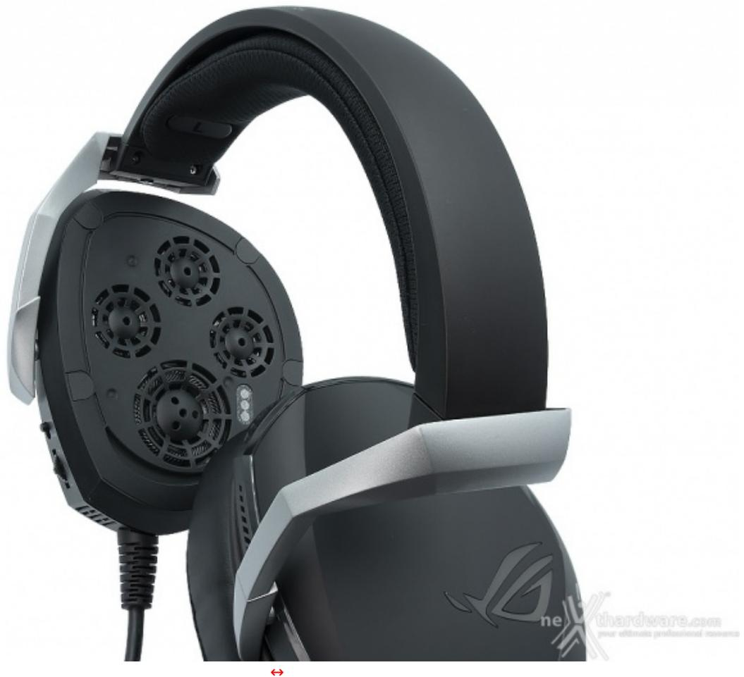
All'interno di ciascun padiglione troviamo dunque un driver da 40mm per la riproduzione dell'audio frontale e altri tre da 30mm destinati, rispettivamente, al centrale, laterale e posteriore.
