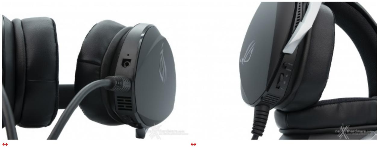
Nella parte bassa del padiglione sinistro troviamo, oltre al connettore da 3,5mm per il collegamento del microfono, uno switch per passare dalla modalità surround 7.1 a quella stereo e una rotella per la regolazione del volume.
