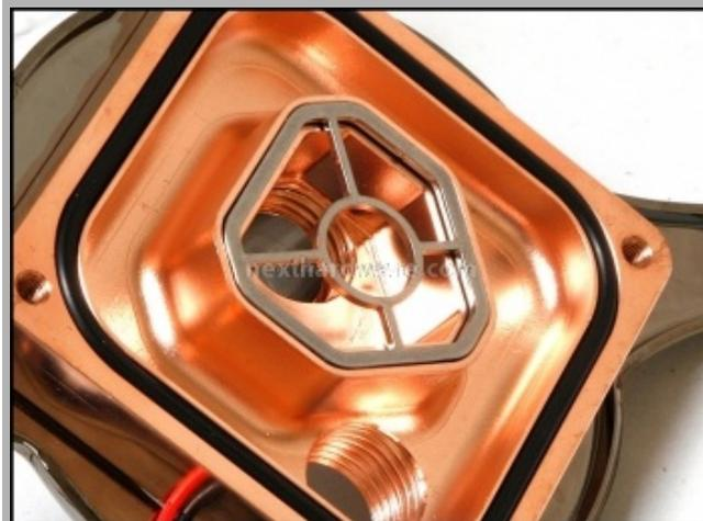
Vista inferiore del top e del diffusore accoppiati. Quest'ultimo risulta incastrato nella parte interna del top.
