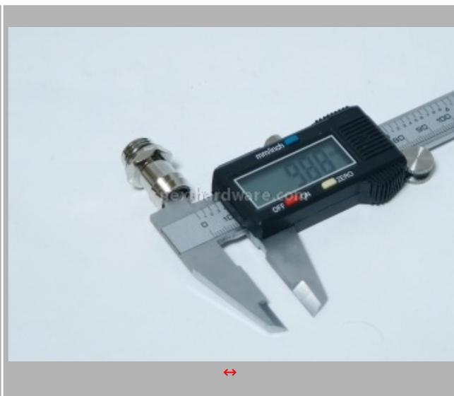
I raccordi in dotazione presentano sulla base uno scavo per accogliere l'o-ring di tenuta. Generoso come di consueto il diametro interno che risulta di poco inferiore ai 10mm.
