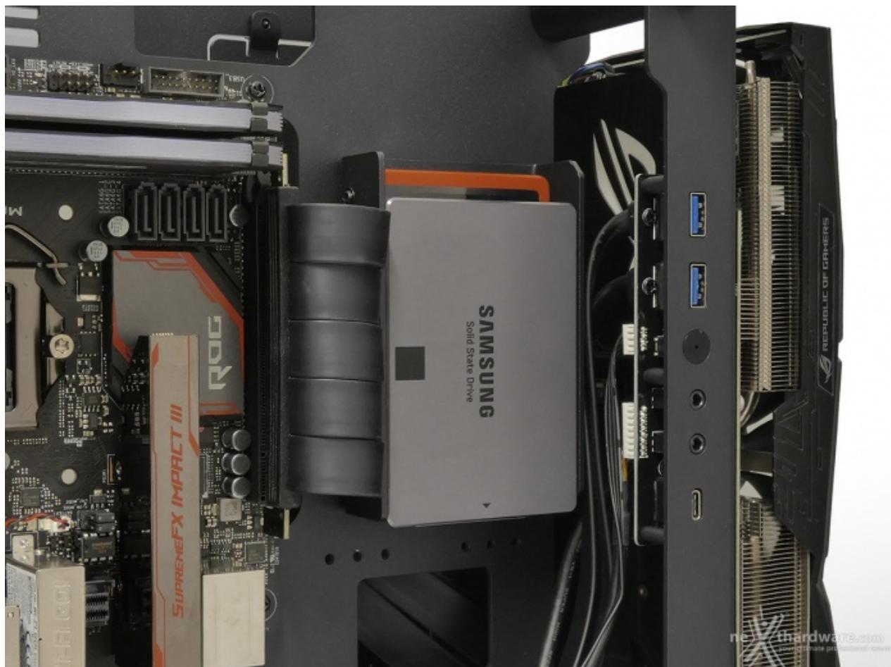
Due drive SSD sono stati montati all'interno dell'apposito supporto che, successivamente, è stato agganciato sul telaio, di fianco alla mainboard.
