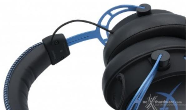
Il sistema di regolazione è affidato al classico archetto di tipo telescopico in grado di estendersi su entrambi i lati, che, unitamente ai due padiglioni basculanti e alle imbottiture in memory foam di buona qualità , assicura un'ottima vestibilità .
