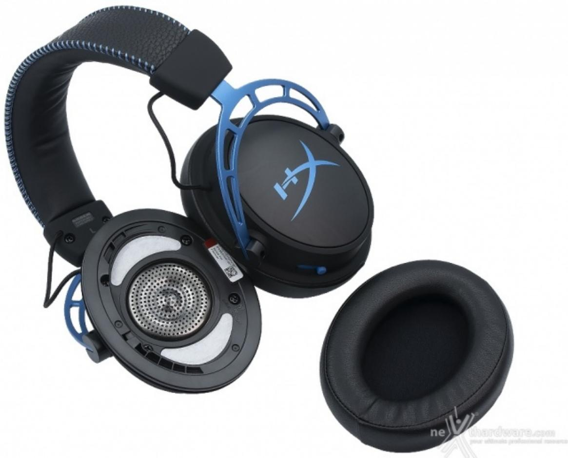
Analogamente a quanto visto sul modello standard, le Cloud Alpha S integrano due driver da 50mm con magneti al neodimio e ciascun padiglione è caratterizzato da una doppia camera di risonanza che permette di avere una maggiore distinzione dei suoni alle varie frequenze e di ridurre al minimo la distorsione.
