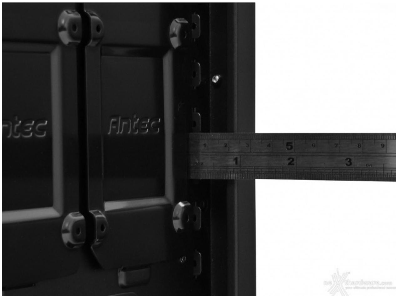
Tra il retro del telaio e la paratia destra vi sono circa 25mm di spazio, più che sufficienti per passare anche i cavi più ingombranti come il 24pin.
