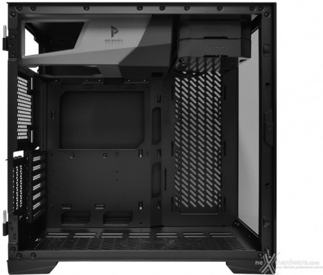
Il vano mainboard, realizzato per l'installazione di modelli in formato E-ATX o inferiore, è contornato da fori per il passaggio dei cavi (inspiegabilmente privi di guarnizioni in gomma) e presenta l'ormai immancabile foro per la manutenzione del sistema di ritenzione dei dissipatori.
