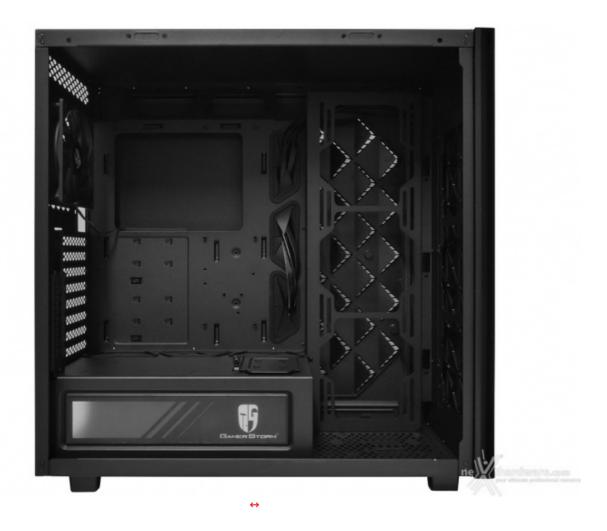
Il piatto mainboard vede, centralmente, l'ormai immancabile foro per il fissaggio e la manutenzione dei sistemi di dissipazione aftermarket ed è contornato da sei asole passacavo dotate di guarnizioni in gomma.
