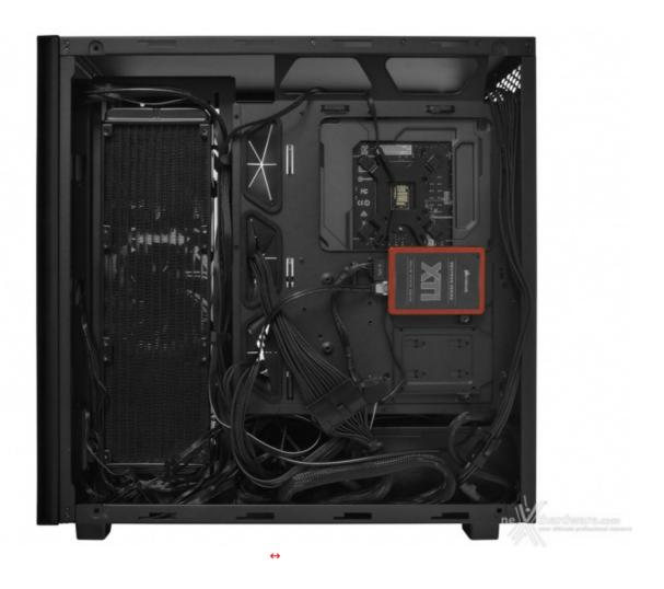
L'ultimo componente a trovare spazio, infine, è stato un drive da 2,5" avvitato ad uno dei due supporti presenti sul retro, poco sotto il foro per la zona socket.
