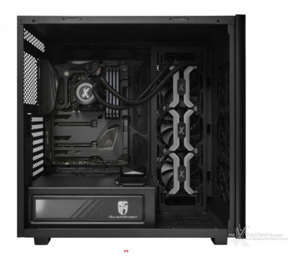
Dopo aver posizionato la nostra mainboard in formato ATX, abbiamo montato, alla sua destra, un All-in-One con radiatore da 360mm dotato di ventole MF120 gestite tramite un controller da 2,5" fissato nel supporto presente sul divisorio del vano alimentatore.
