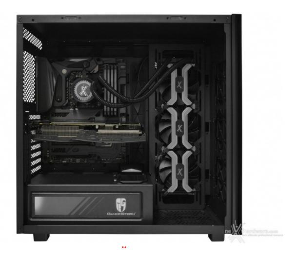
Anche l'installazione della scheda video è stata effettuata in modo facile e veloce, in quanto il case è in grado di ospitare modelli lunghi sino a 310mm in presenza di ventole da 140mm a destra del piatto mainboard.
