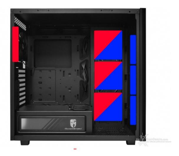
A destra del piatto mainboard è possibile montare tre ventole da 120 o 140mm; tale predisposizione è quella che consigliamo di usare, soprattutto nel caso in cui si volesse optare per un sistema di raffreddamento a liquido, dal momento che quella frontale non garantisce un flusso ottimale.
