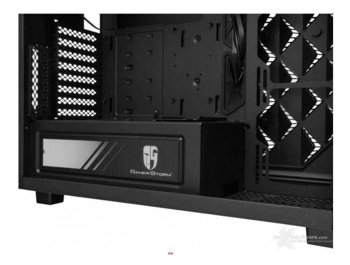
Il coperchio per il vano alimentatore è anch'esso realizzato in acciaio e presenta, nella parte alta, un supporto per drive da 2,5" e, lateralmente, un foro rettangolare dal quale, rimuovendo la cover GamerStorm, sarà possibile vedere l'alimentatore.
