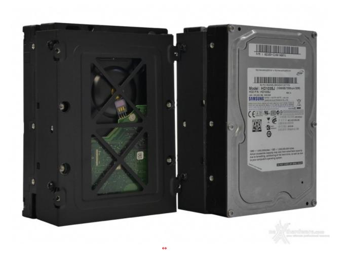
La stessa predisposizione può essere utilizzata per il fissaggio dei cestelli da 3,5" presenti in dotazione, per un massimo di quattro drive.
