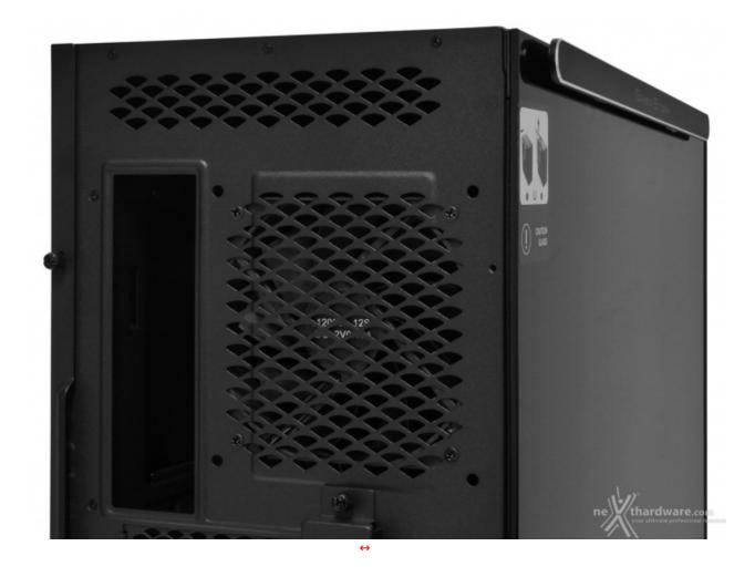
Analizzando il retro del case possiamo notare che, in realtà , il top avrebbe potuto accogliere radiatori abbastanza generosi, visto che tra la parte superiore del telaio e il foro per l'I/O Shield vi è una griglia alta circa 50mm ma, inspiegabilmente, tale possibilità non è stata offerta.
