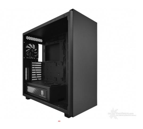
Alla destra della scheda madre è possibile installare tre ventole da 120 o 140mm, con tanto di radiatore per il liquido.
