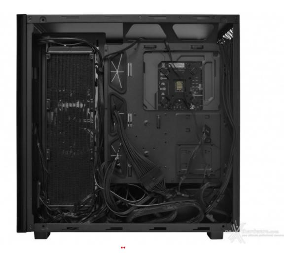
Per quanto concerne l'alimentatore abbiamo utilizzato delle prolunghe di buona qualità ed esteticamente appaganti e, grazie ai 300mm a disposizione, siamo riusciti a gestire i cavi in modo impeccabile escludendoli completamente dal retro del radiatore, in modo tale da consentire un flusso di aria ottimale.
