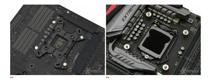
Il primo step consiste nel predisporre il backplate sulla parte posteriore della scheda madre e, successivamente, posizionare sulla parte opposta i supporti in plastica su cui verranno montate le due staffe di ritenzione.
