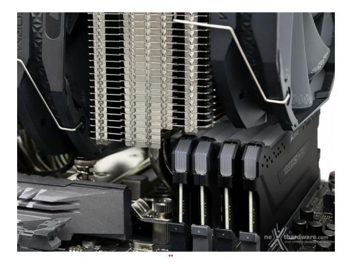
Ovviamente, l'utilizzo di quattro moduli di RAM ad alto profilo vi costringerà a installare la ventola esterna in posizione rialzata, con tutti gli svantaggi dovuti all'incremento delle dimensioni in altezza.
