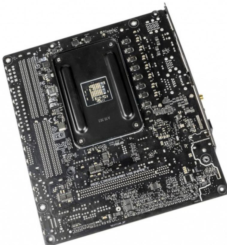
La parte posteriore presenta in bella vista le due fasi di alimentazione per il SOC nella parte alta, insieme ad una serie di SMD (surface-mount devices) che si occupano della stabilizzazione della corrente, come i condensatori a polimeri d'alluminio intorno alla zona socket, permettendo alla parte frontale della scheda madre di mantenere un layout più ordinato.
