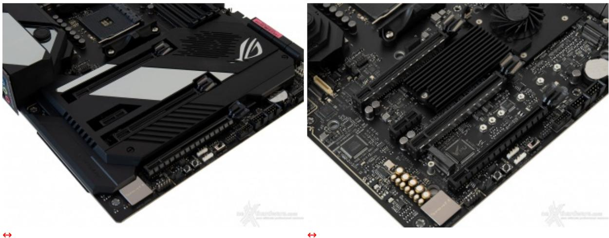
Nella foto in alto possiamo osservare la dotazione di slot PCI-E, di cui due x16 Gen4 pilotati dalla CPU, un x16 Gen4 ed un x1 Gen4 gestiti invece dal Fusion Controller Hub (FCH).
