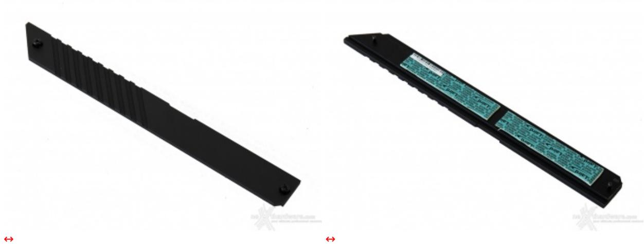
I due connettori beneficiano della presenza di un dissipatore passivo in alluminio dotato di un buon numero di alette che va ad interfacciarsi con i drive sottostanti tramite un pad termico.
