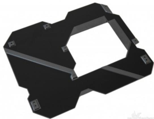
La stessa è ancorata al PCB tramite otto viti di adeguate dimensioni e, una volta smontata, possiamo facilmente dedurne la duplice funzione, ovvero come rinforzo strutturale contro eventuali flessioni di quest'ultimo e come dissipatore di calore grazie alla presenza di pad termoconduttivi.
