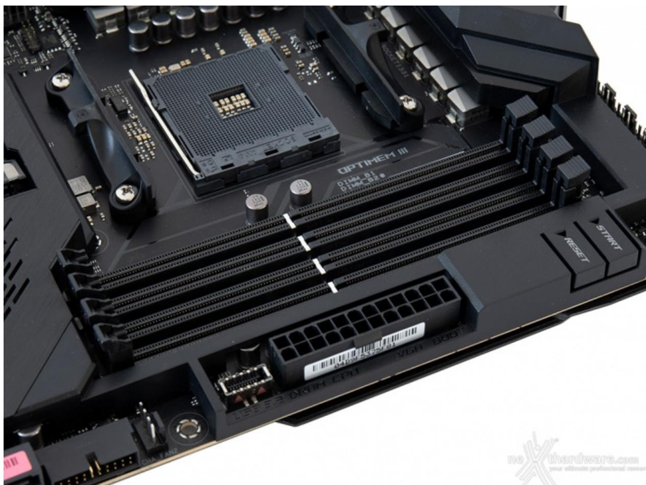
Il comparto dedicato alle memorie presenta quattro slot DIMM di colore nero in grado di ospitare un quantitativo massimo di 128GB di DDR4, ovvero sino a quattro moduli da 32GB l'uno (in modalità dual channel) dotati di profili Intel XMP 2.0 per la configurazione automatica dei relativi parametri di funzionamento.
