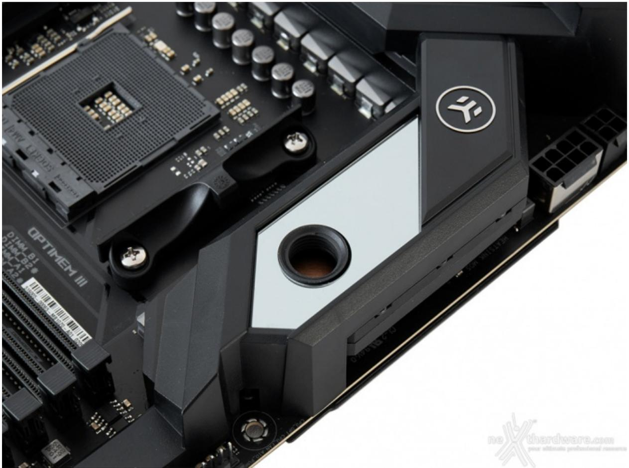
Il sistema di raffreddamento ibrido della sezione di alimentazione della ASUS ROG Crosshair VIII Formula è una delle peculiarità che la distingue rispetto alle altre mainboard della serie che, invece, adottano un sistema completamente passivo.
