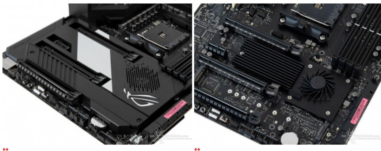
Il raffreddamento del chipset è invece affidato ad un dissipatore in alluminio a basso profilo dotato di una sezione alettata e di un'altra priva di alette sulla quale è fissata una ventola di raffreddamento controllabile direttamente dal BIOS o tramite l'applicativo Fan Xpert 4.
