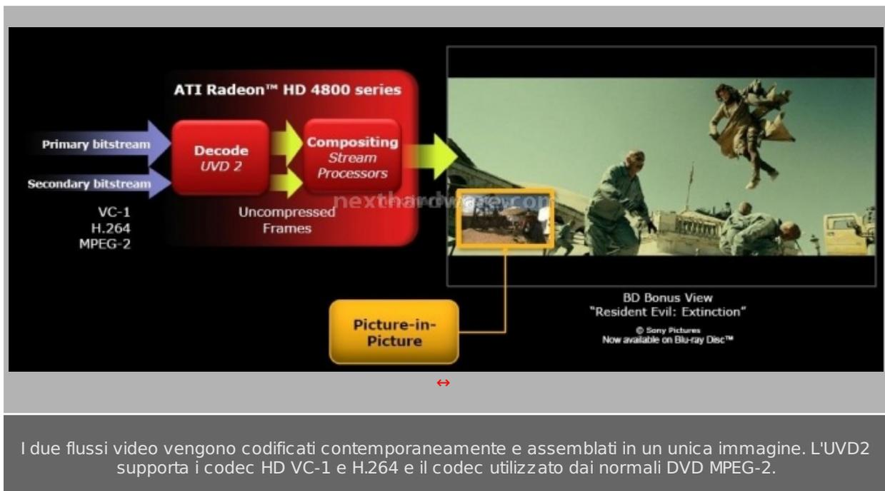
I due flussi video vengono codificati contemporaneamente e assemblati in un'unica immagine. L'UVD2 supporta i codec HD VC-1 e H.264 e il codec utilizzato dai normali DVD MPEG-2.
