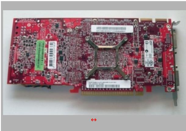
Sul retro del PCB non sono installati componenti significativi ad eccezione della staffa di fissaggio del sistema di raffreddamento.
