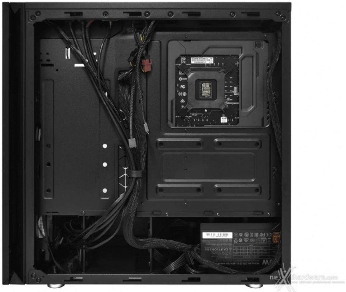
In seguito, rimuovendo la paratia destra, abbiamo posizionato l'alimentatore MasterWatt 750W all'interno del suo scomparto sistemando, contemporaneamente, i cavi d'alimentazione per CPU e scheda video.
