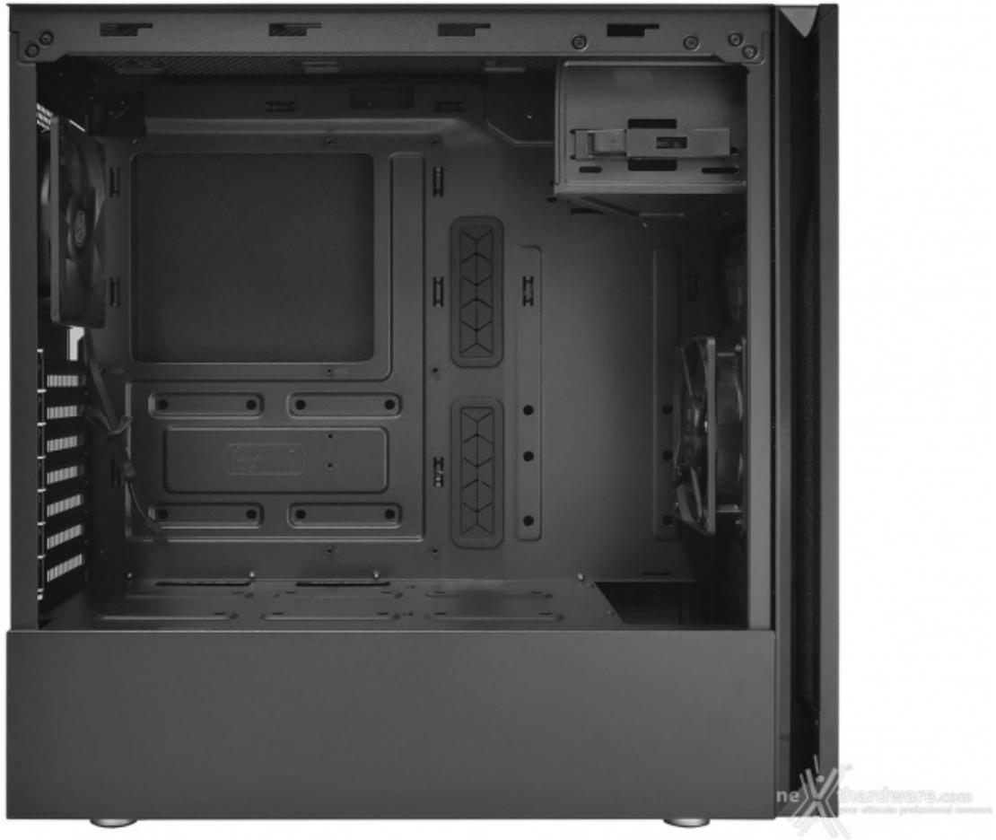
In corrispondenza della zona CPU vi è un ampio scasso per la manutenzione e l'installazione dei sistemi di raffreddamento mentre, poco più a destra, vi sono due grandi fori con guarnizioni in gomma adibiti al passaggio dei cavi.
