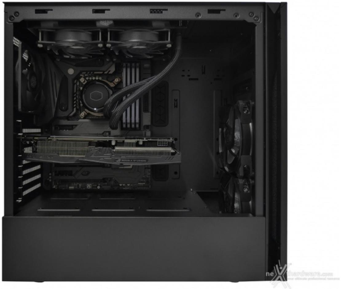
Dato l'ampio spazio a disposizione, ben 398mm, l'installazione della scheda video si è rivelata molto semplice.
