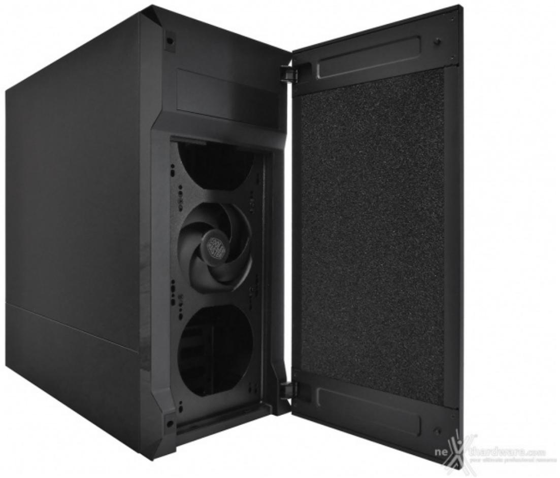
Quest'ultimo è posto a protezione di una predisposizione per due ventole da 120 o 140mm che, di serie, è occupata da una unità Silencio da 120mm.
