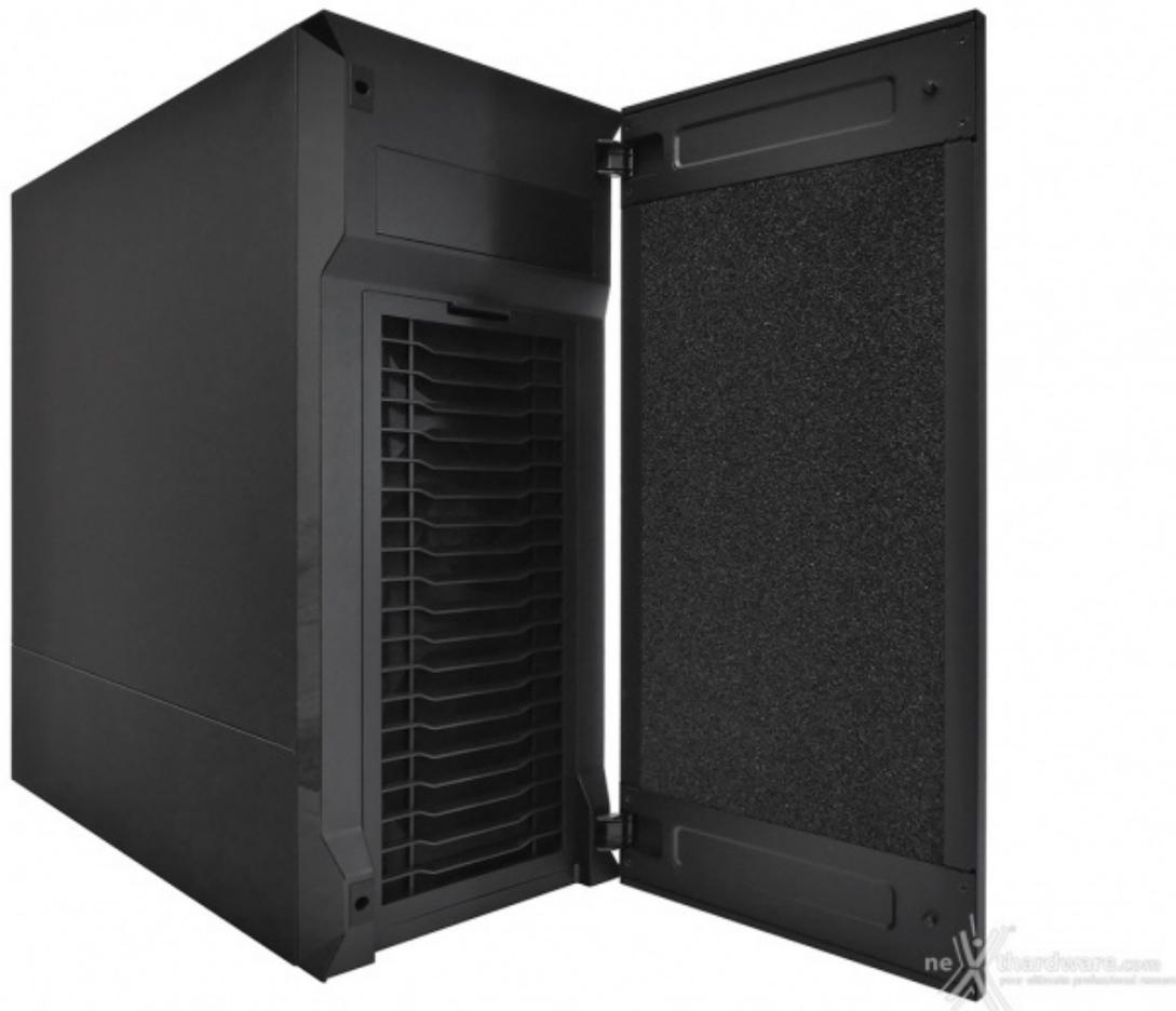
Dietro di esso è nascosto un coperchio per la predisposizione per un drive da 5,25" ed un filtro antipolvere removibile.
