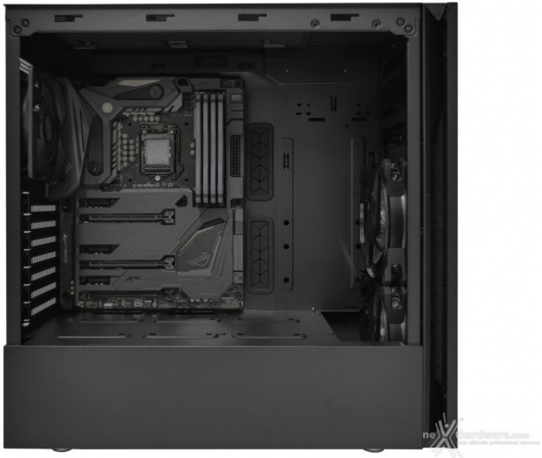
Il primo componente a trovare spazio all'interno dell'ampio vassoio è stata la scheda madre, completa di CPU, RAM e drive M.2.
