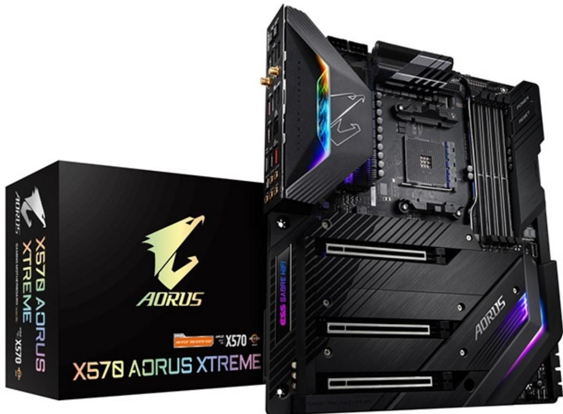
Nel corso della recensione odierna andremo ad analizzare la top di gamma X570 AORUS XTREME, dotata di un sistema di alimentazione digitale Infineon con design a 16 fasi da 70A ognuna per garantire la massima stabilità operativa.
