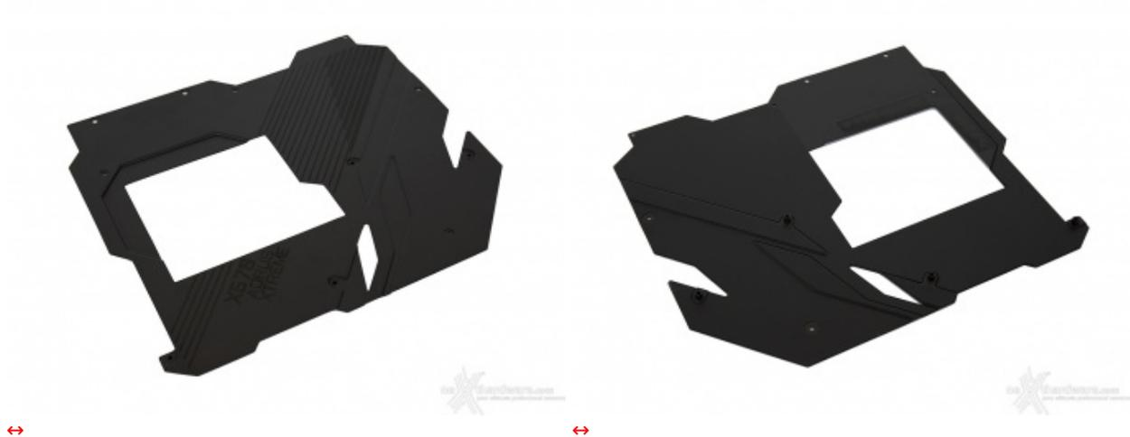
Dissipatori a parte, un ottimo contributo allo smaltimento del calore viene fornito anche dall'armatura in metallo posta sul retro del PCB vista in precedenza.
