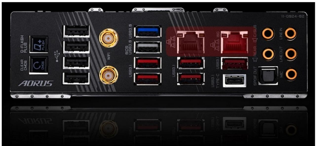
La porta di sinistra è pilotata da un controller Intel i211AT che supporta la tecnologia cFos Speed, ovvero un sistema di gestione del traffico di rete che, tramite uno specifico software, permette di migliorare la latenza riducendo al minimo il ping anche sulle reti più affollate.
