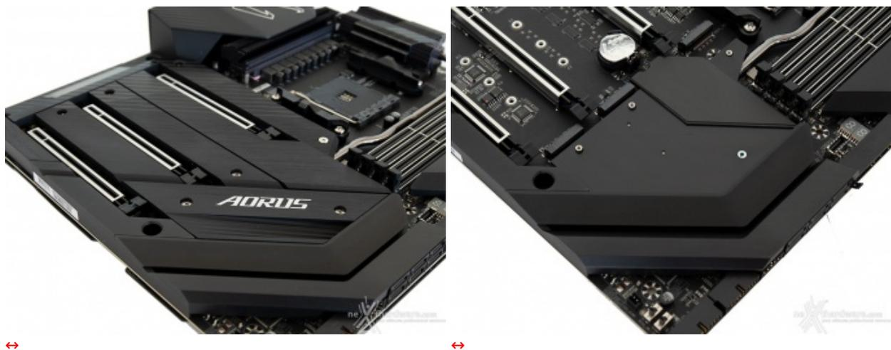
Il dissipatore dedicato al chipset X570, invece, è del tipo a basso profilo ed è realizzato in alluminio pressofuso.
