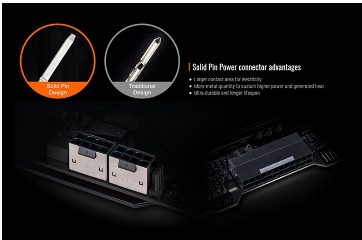
Anche questa scheda, al pari di tutte le top di gamma AORUS, adotta la tecnologia Solid Pin che prevede l'utilizzo di elementi interamente in metallo in luogo di quelli vuoti all'interno, sia per i due connettori sopraccitati che per quello ATX 24pin.
