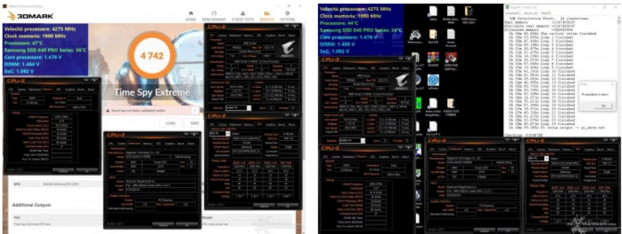
**Test massima frequenza RAM (sincrono) - 3800MHz 16-18-18-38 1T**
