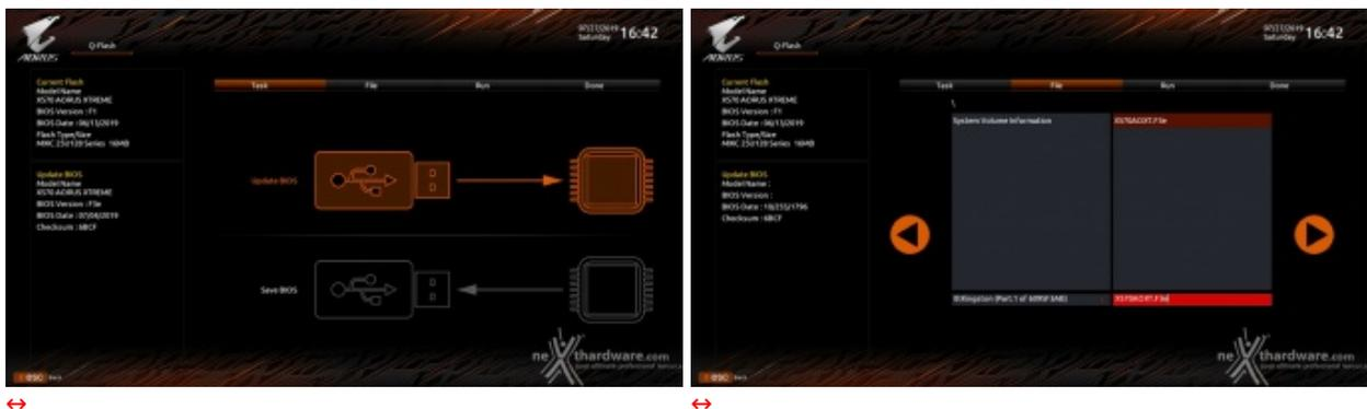
La sezione "Q-Flash", accessibile da tutte le pagine tramite l'apposita Tab, permette di effettuare l'aggiornamento del BIOS tramite un Flash Drive USB, ma anche di effettuare il backup dello stesso sul chip secondario in maniera tale da tenerlo costantemente aggiornato all'ultima versione.
