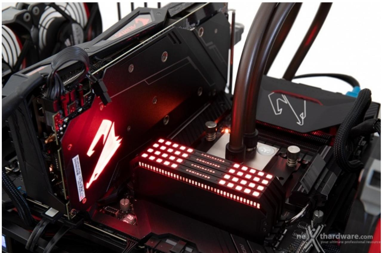
Il sistema di raffreddamento a liquido utilizzato, composto da un waterblock EK Supreme EVO AMD, un radiatore triventola ed una pompa Swiftech MCP355, nonostante l'elevata temperatura estiva, si è comportato in maniera impeccabile riuscendo a tenere a bada il processore in prova anche quando siamo andati ad alzare la tensione operativa.
