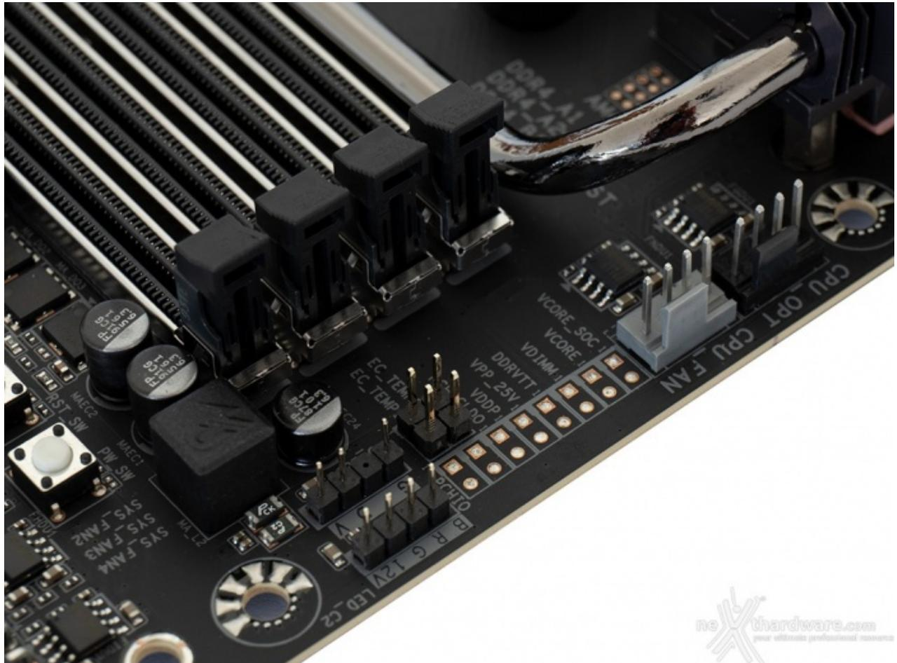
Sul lato superiore sono invece situati otto punti di misura che consentono di verificare, con l'ausilio di un multimetro, le tensioni dei principali componenti del sistema.
