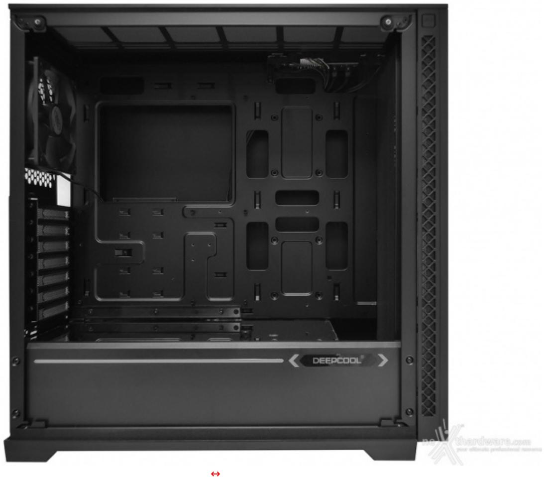
Il piatto mainboard è dotato di un ampio scasso rettangolare per l'installazione e la manutenzione dei sistemi di raffreddamento aftermarket per CPU e vede la presenza di otto feritoie per il passaggio dei cavi, prive di guarnizioni in gomma.
