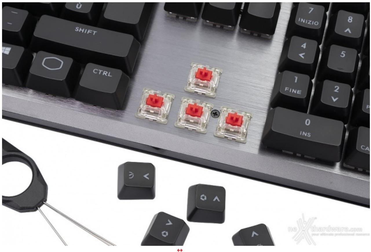
Come detto, la MasterKeys MK850 è equipaggiata con i classici switch CHERRY MX Red, ma otto di questi, nello specifico quelli relativi ai tasti Q,W,E,R,A,S,D,F, sono dotati di una particolare tecnologia brevettata da Aimpad, startup con la quale Cooler Master ha chiuso un accordo di esclusiva fino al 2020, che li rende del tutto analogici.
