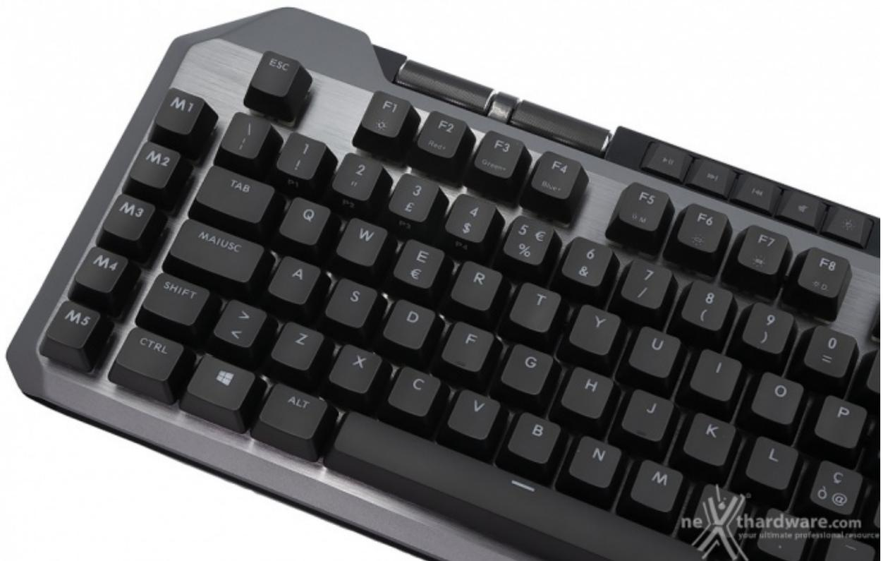
La zona superiore sinistra accoglie due rotelle di scroll in metallo texturizzato, di cui una (quella più a destra) permette di alzare e abbassare finemente, a step di due punti percentuali, il volume di sistema, mentre l'altra consente di regolare l'intensità luminosa.
