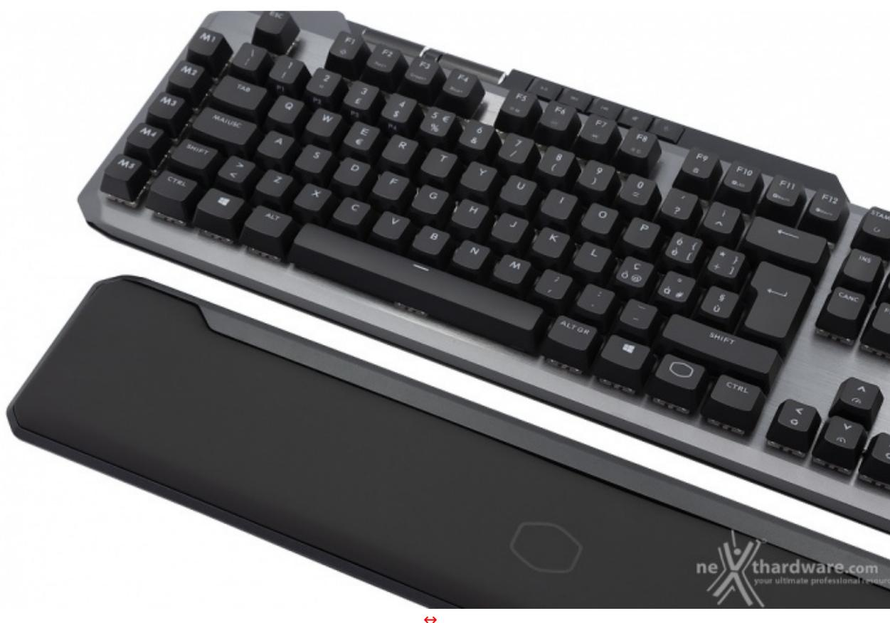
Davvero pratico e ben rifinito il poggiapolsi fornito in dotazione, con rivestimento in similpelle ed un'imbottitura di ottima fattura, la cui installazione risulta semplice ed immediata grazie al sistema di fissaggio magnetico.
