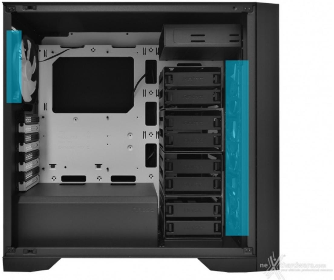
Oltre alla possibilità di installare un radiatore da 140 o 120mm sul retro, il case è in grado di contenere anche un radiatore da 360mm o inferiore posizionato frontalmente, senza dover rinunciare a tutti e otto i supporti per drive.
