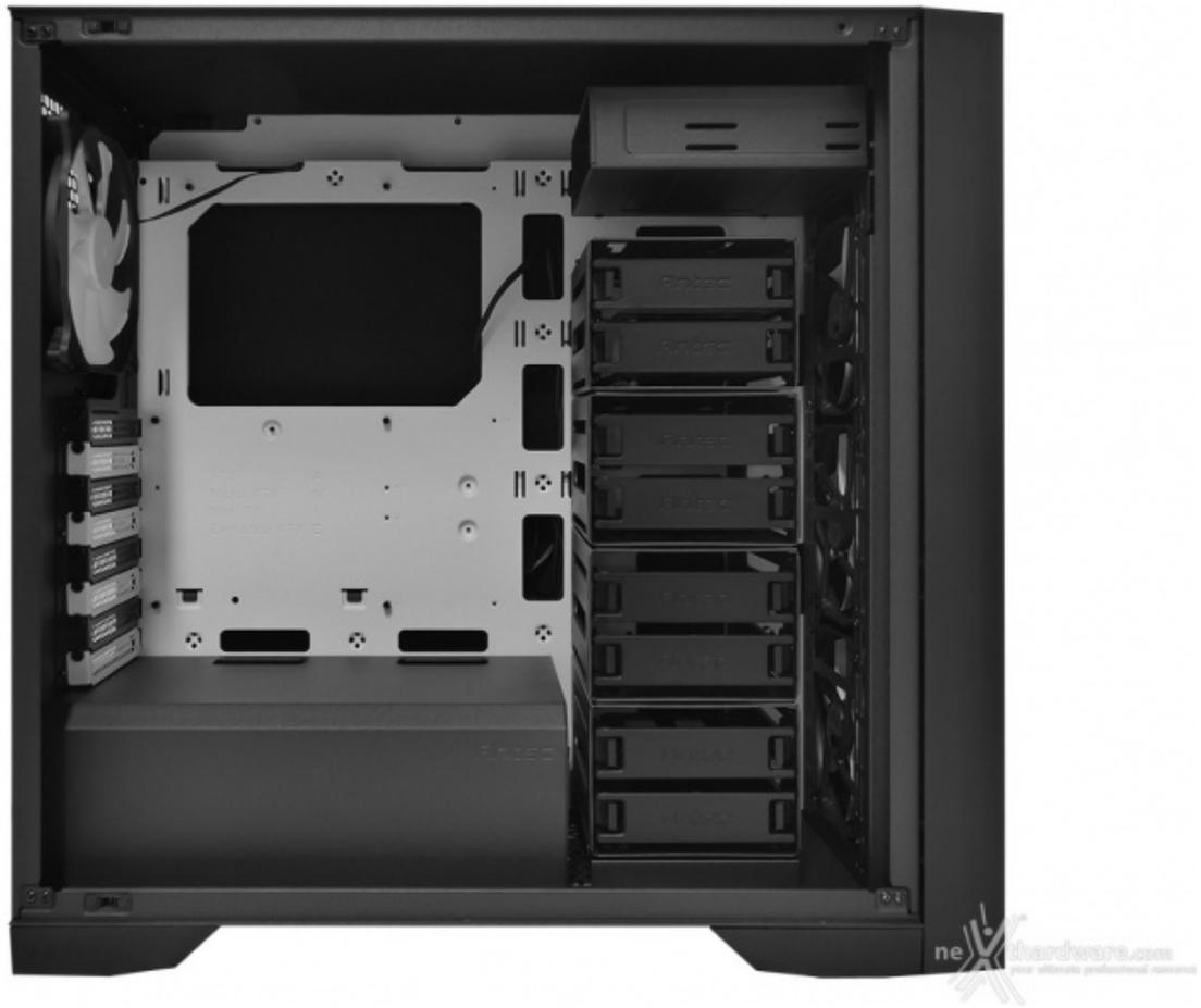
L'ampio piatto mainboard, totalmente bianco ed in grado di contenere schede madri in formato E-ATX o inferiore, presenta un ampio scasso per la manutenzione dei sistemi di ritenzione dei dissipatori ed è contornato da sette fori per il passaggio dei cavi, più che sufficienti anche per configurazioni multi GPU.
