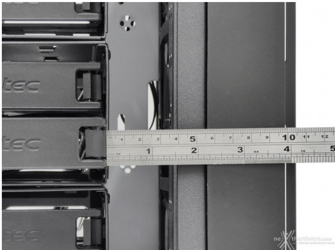
Il radiatore frontale non dovrà superare i 40mm di spessore, tuttavia, nel caso in cui volessimo montarne uno di maggior spessore o optare una configurazione push-pull, la rimozione dei cestelli eliminerà questa limitazione.
