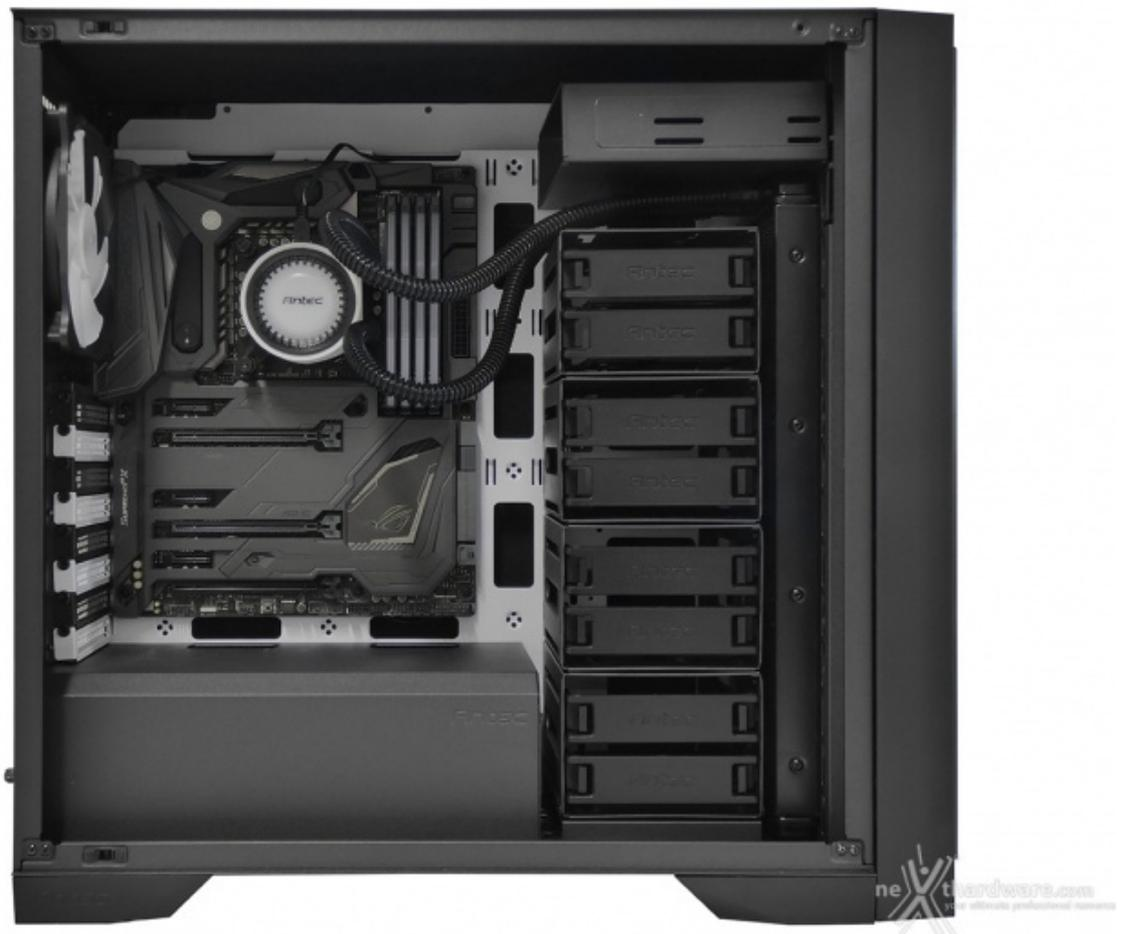
A seguire abbiamo montato il sistema di raffreddamento a liquido Antec Mercury con radiatore da 360mm posizionato sul frontale.
