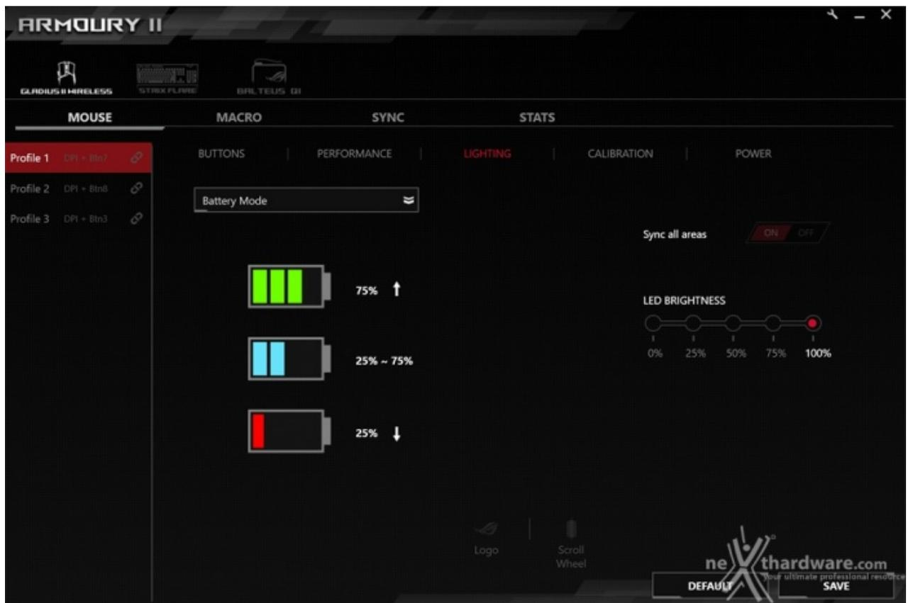
Molto interessante l'ultima opzione, "Battery Mode", che andrà ad illuminare il mouse in modalità respiro con tre diverse colorazioni possibili a seconda dello stato di carica della batteria.
