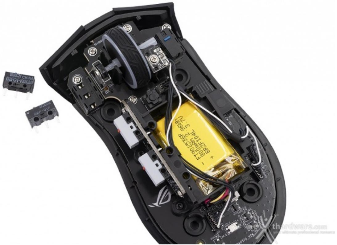
Una volta aperto il mouse cambiare gli switch è comunque molto semplice, in quanto non sono saldati ma si innestano sul socket grazie ai tre pin di contatto.
