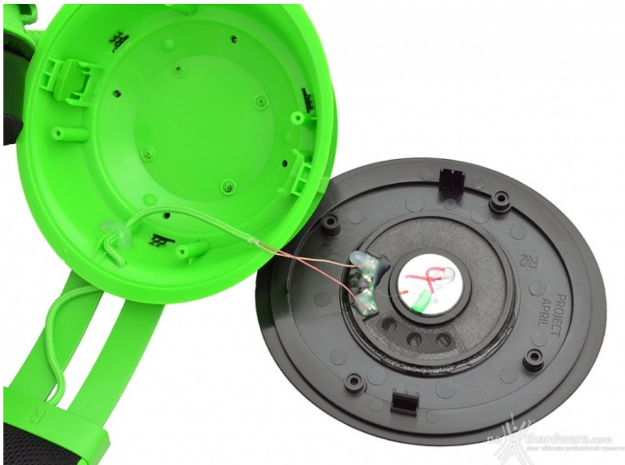
Una volta rimosse le quattro viti esagonali che chiudono saldamente le due parti che compongono il padiglione, avremo accesso al driver al neodimio di cui sono dotate le nuove Kraken.
