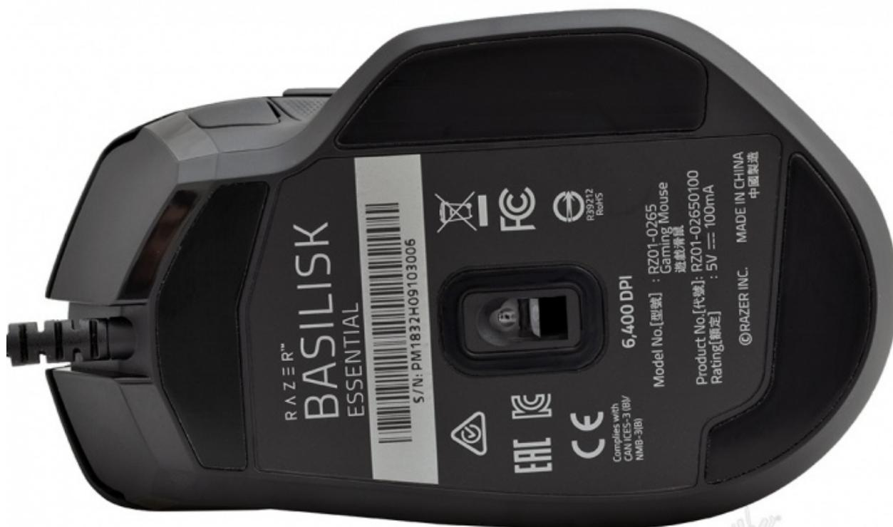
La disposizione dei padsurfer in teflon è ampia come nella maggior parte degli ultimi modelli di casa Razer, con un bordo "stabilizzatore" attorno all'apertura del sensore ottico PixArt SDNS-3988 da 6400 DPI massimi, un valore decisamente inferiore ai 16000 DPI offerti dal sensore ottico 5G del Basilisk FPS.
