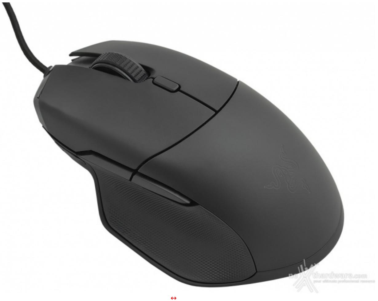
Il layout si compone dei soliti tre pulsanti di base (di cui i principali equipaggiati con i Mechanical Mouse Switch) più due laterali ed uno dorsale, tutti configurabili unitamente alla levetta laterale opzionale, o Clutch, disposta sul lato sinistro in posizione avanzata, esclusiva di Razer e denominata Multi-Function Paddle.
