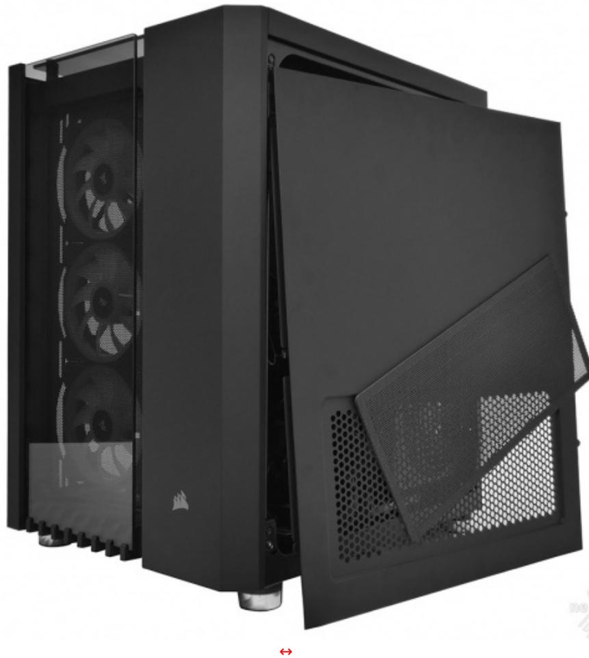
Quella destra, invece, è in robusto acciaio e presenta un'ampia griglia di aerazione dotata di apposito filtro calamitato, che si occuperà del corretto ricircolo d'aria della zona alimentatore.
