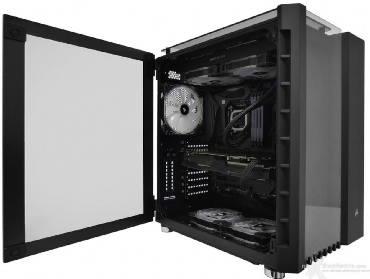
Ad assemblaggio concluso, non essendo ancora soddisfatti del nostro lavoro, abbiamo deciso di montare altre due ventole HD120 RGB sul fondo, collegandole direttamente agli header Fan Connect II della nostra ROG STRIX GTX 1070 Ti.
