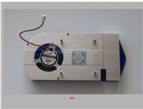
A differenza della reference board di AMD/ATI, dotate di dissipatore in rame con placca di raffreddamento per le memorie, Sapphire ha optato per una soluzione in alluminio piuttosto silenziosa. Il calore prodotto dalla scheda non è mai eccessivo e le ridotte dimensioni, ne consentono l'installazione in una grande varietà di case.
