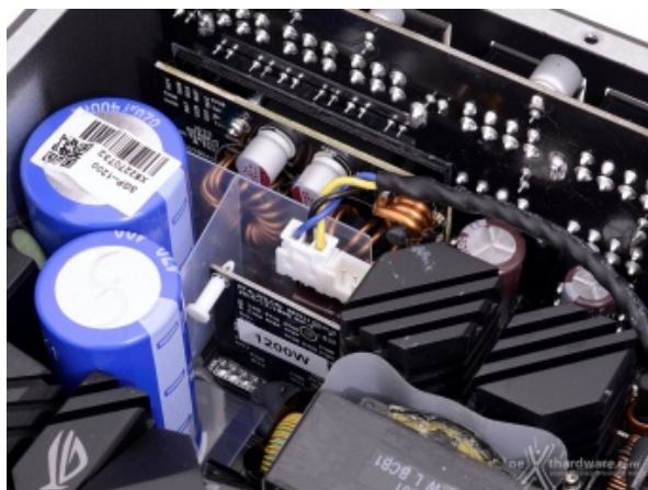
Particolare della daughter-card che ospita i moduli DC-DC.
