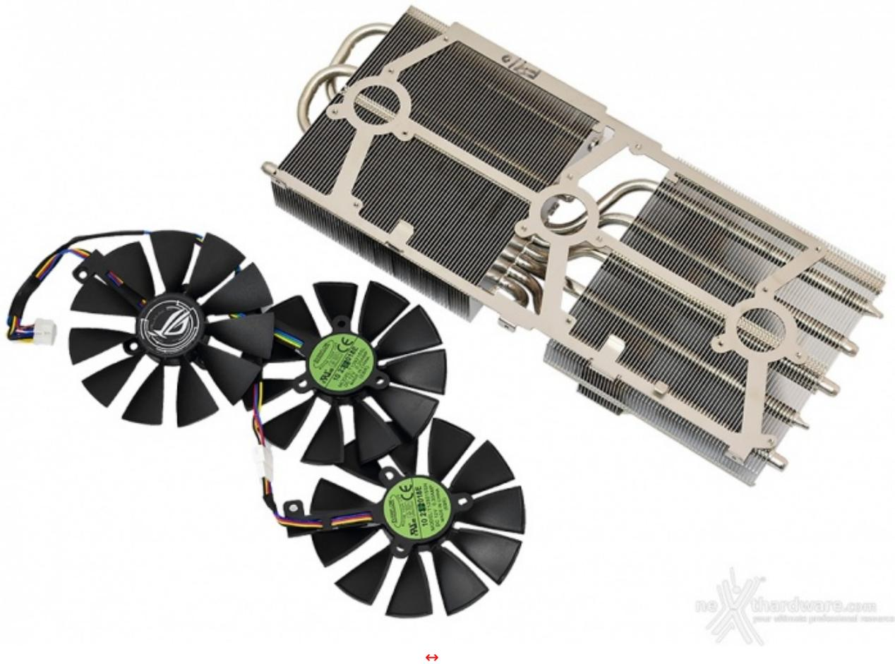
Il corpo dissipante, già visto su alcuni modelli di scorsa generazione (GTX 1080 Ti e GTX 1070 Ti), presenta dimensioni e peso decisamente importanti, con ben sei heatpipes da 6mm che si occupano di veicolare il calore prodotto dalla GPU verso le numerose alette.
