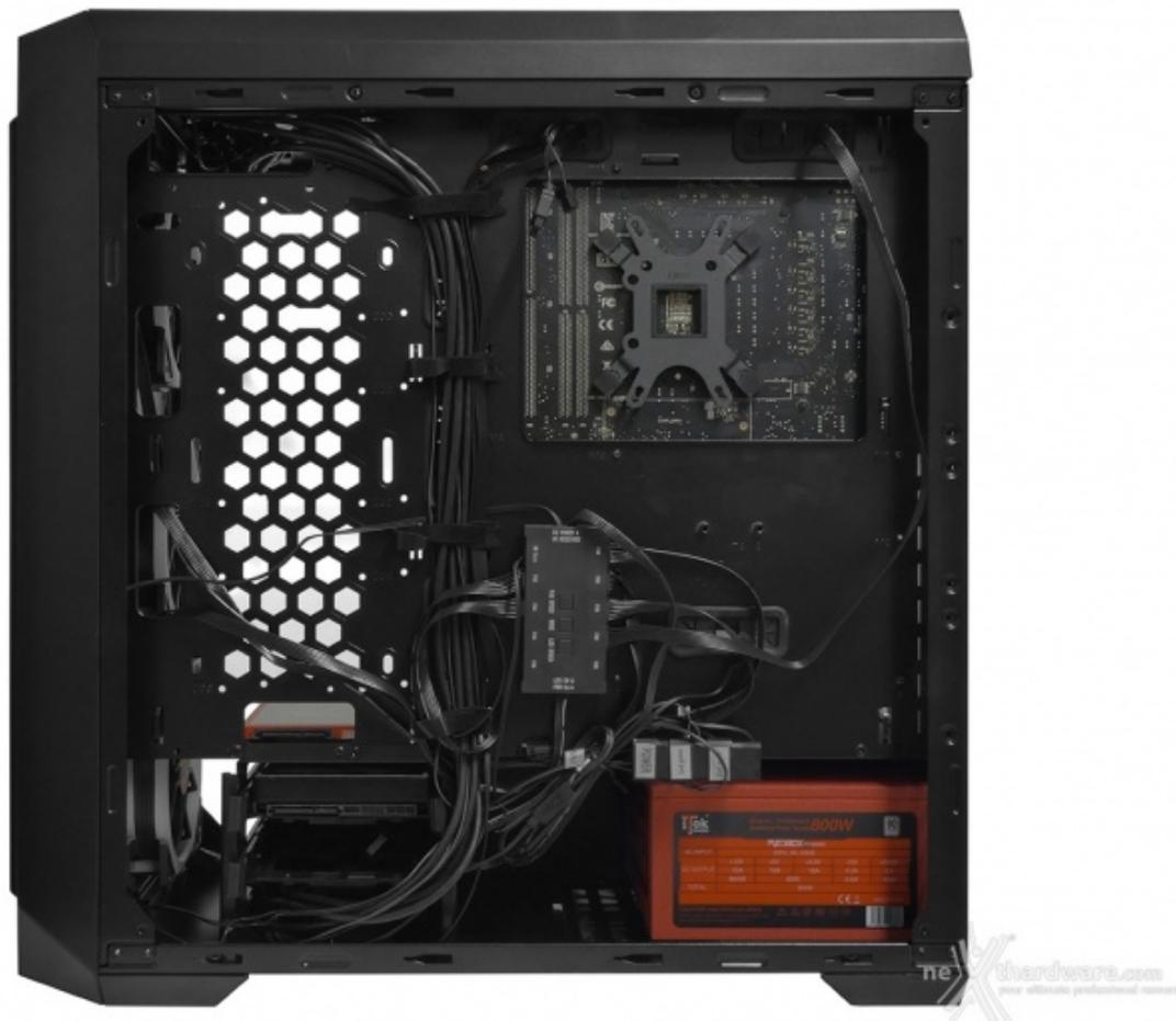
Quest'ultimo, un iTek REDBOX da 800W, è stato montato con estrema facilità nel vano a lui dedicato, in quanto non è necessaria la rimozione del coperchio soprastante per poter agire al suo interno.
