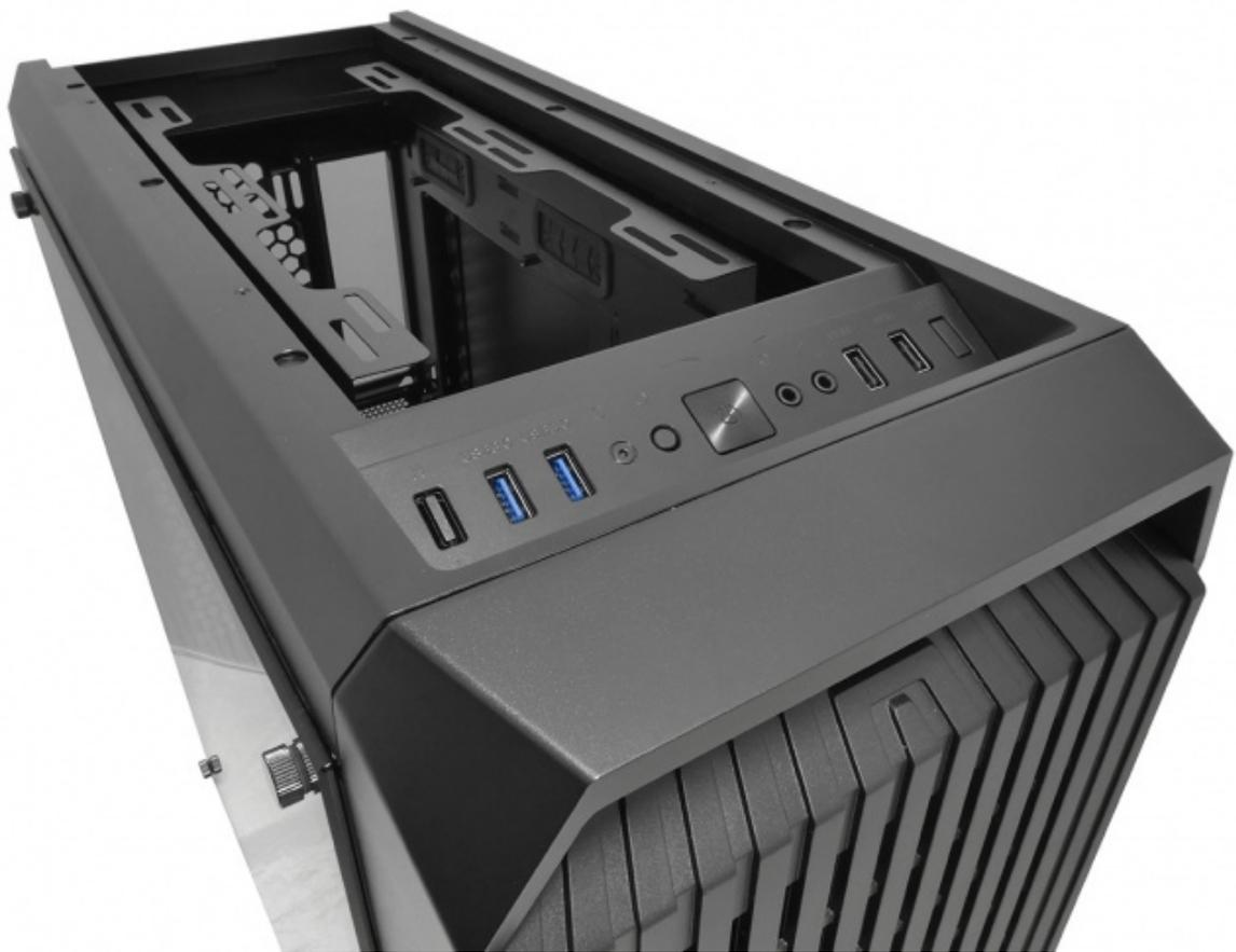
In alto è possibile osservare la seconda predisposizione per ventole, in grado di ospitarne due da 120 o 140mm.
