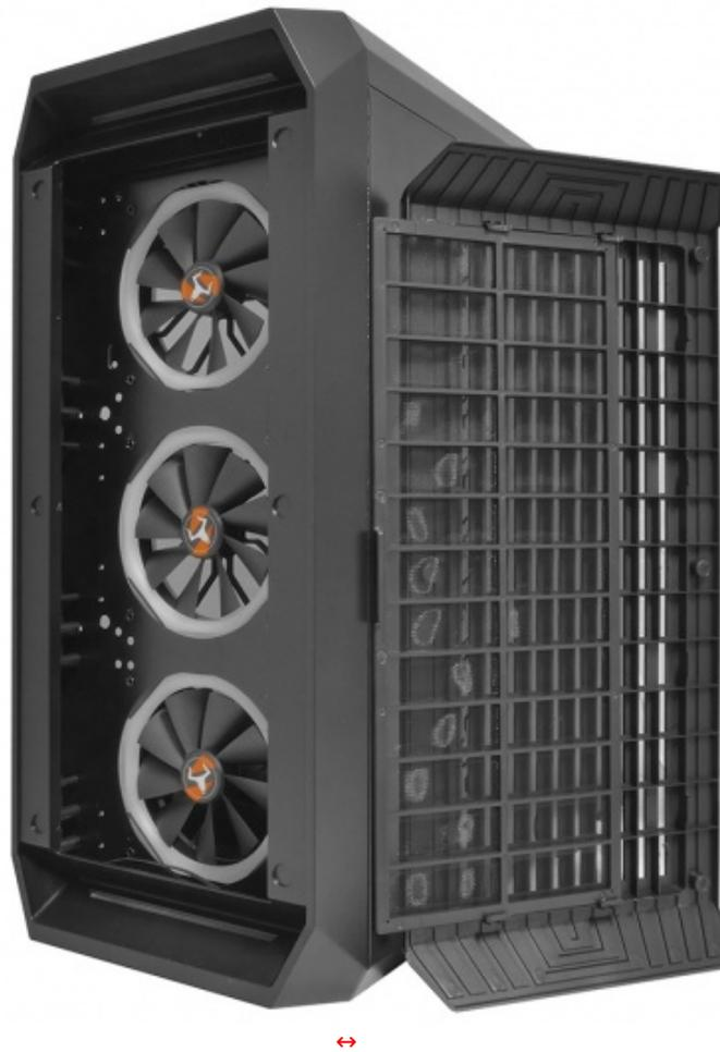
Parte della copertura in plastica può essere facilmente rimossa, in quanto fermata al telaio tramite calamite.
