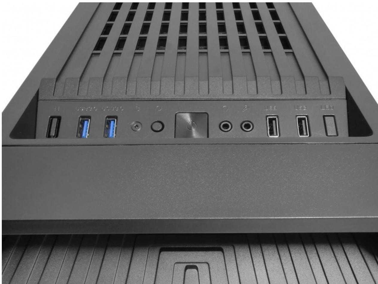
Nella parte anteriore alta del case, oltre ad una maniglia per il trasporto dotata di striscia a LED, è posizionato il pannello di I/O comprendente due porte USB 2.0, due USB 3.0, due jack HD Audio, i pulsanti di accensione e reset e quello per poter controllare il sistema di illuminazione del case, separato da quello integrato nelle ventole.
