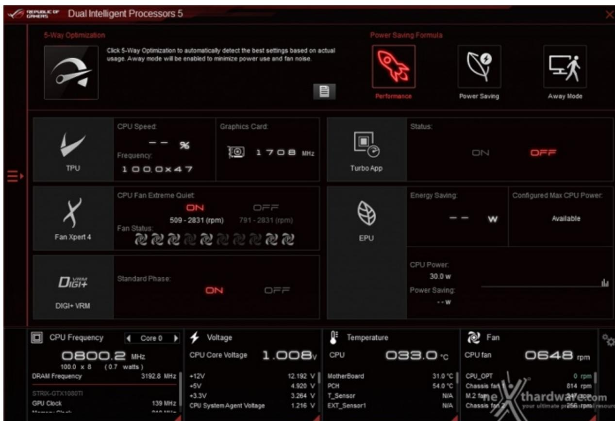
La schermata principale, che ricorda molto quella dell'UEFI BIOS delle schede madri ROG, mostra tutte le principali informazioni del sistema come il clock della CPU e della GPU, le tensioni, le temperature e l'attività delle ventole.
