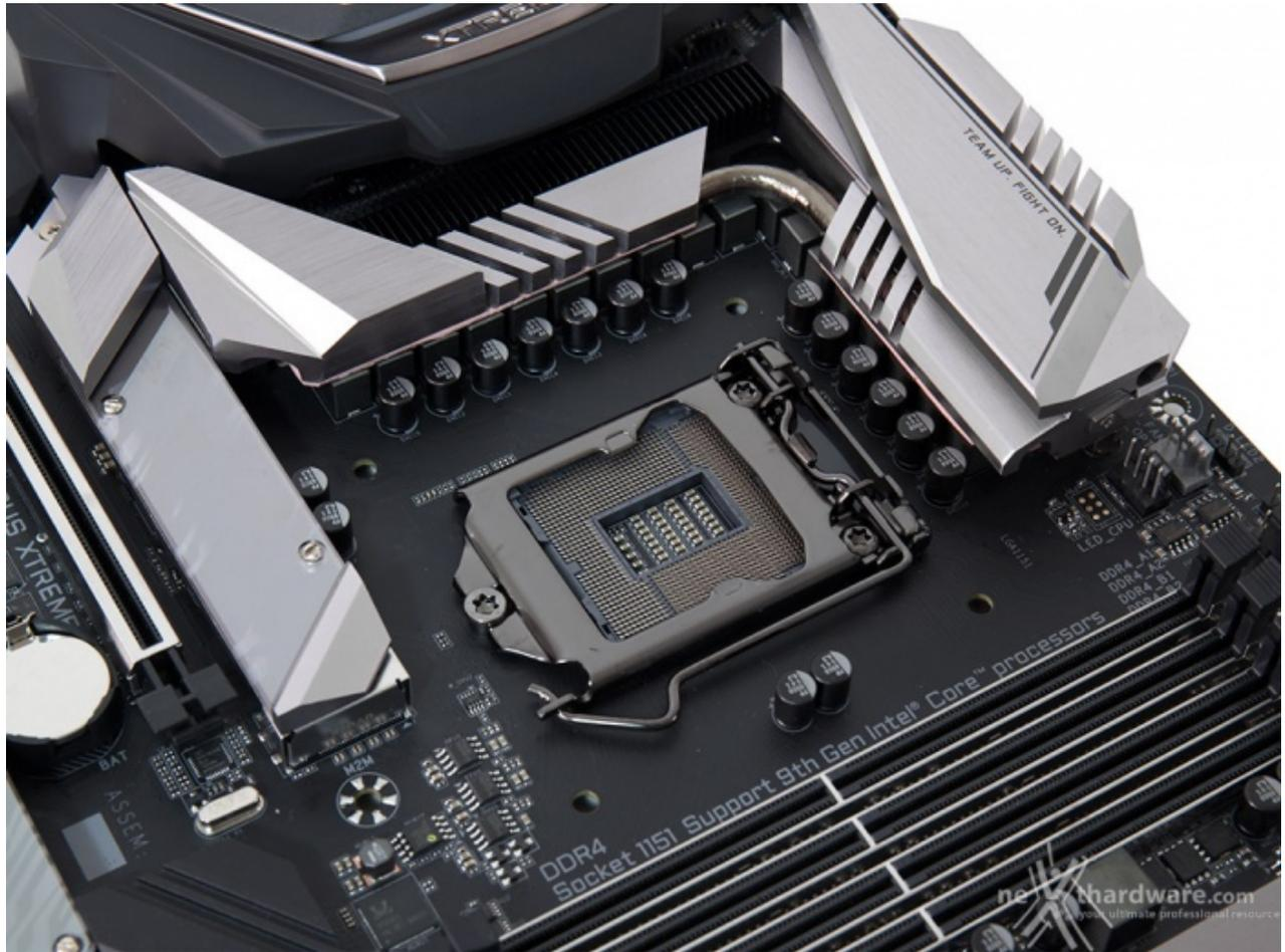
Il socket utilizzato è il nuovo LGA 1151 V2 in grado di garantire il pieno supporto alle CPU Intel Coffee Lake-S di 8a e 9a generazione, ma incompatibile dal punto di vista elettrico con i processori precedenti.
