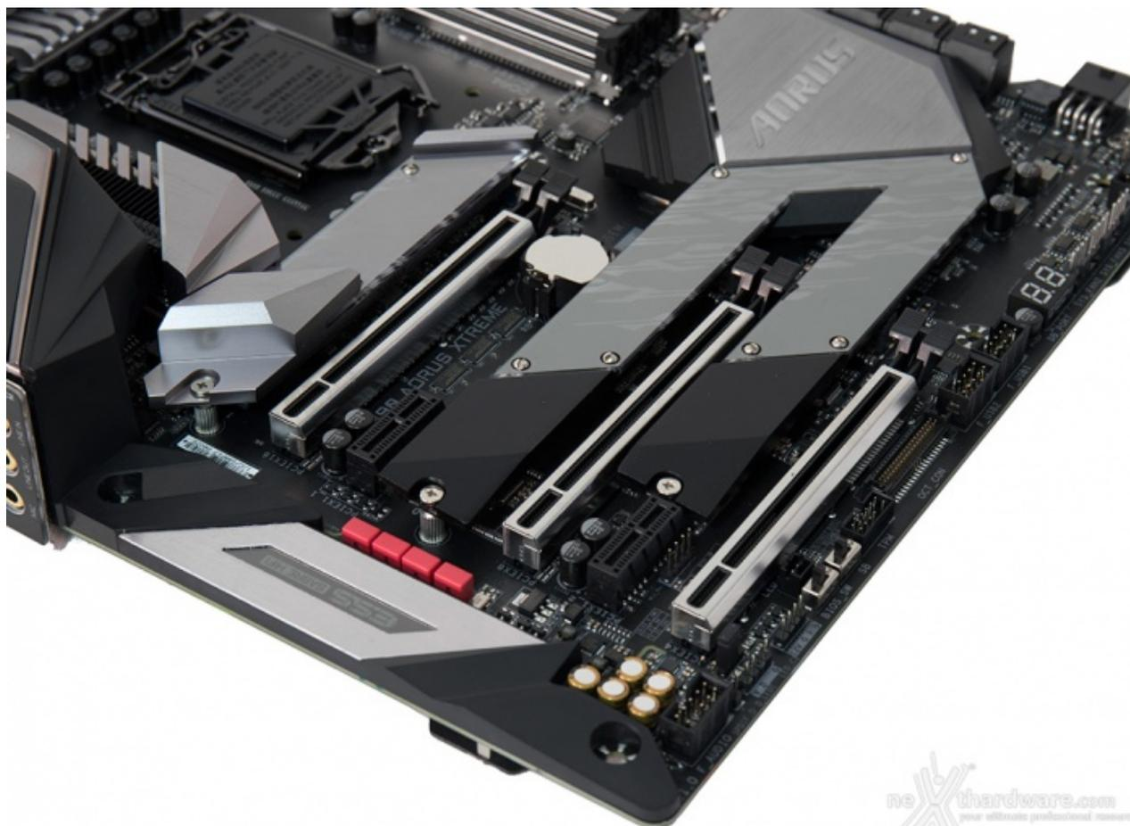
L'immagine in alto ci mostra la dotazione di slot PCI Express comprendente due PCIe 3.0 x1 ed altri tre PCIe 3.0 x16 funzionanti, rispettivamente, in modalità x16, x8 e x4.
