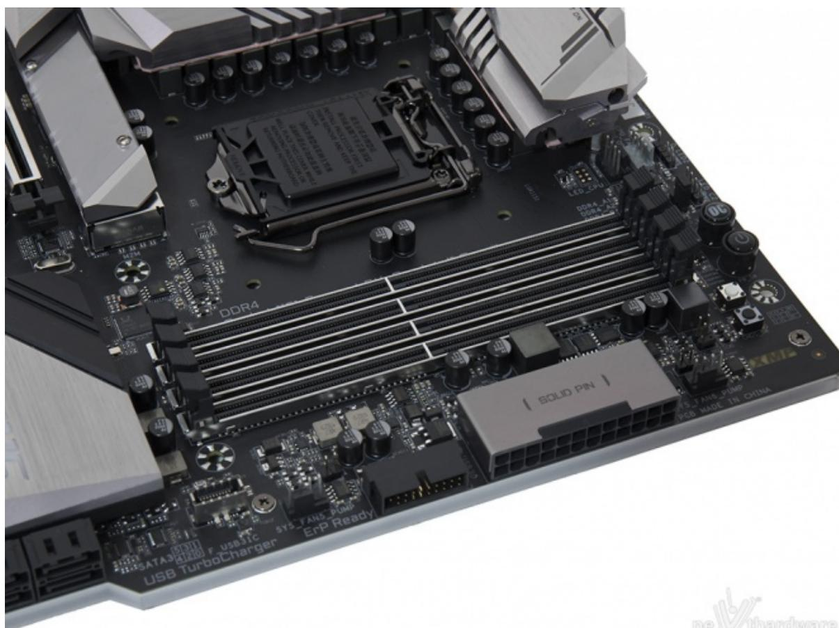
Il comparto dedicato alle memorie presenta quattro slot DIMM in grado di ospitare un quantitativo massimo di 128GB di DDR4 con frequenze fino a 4400MHz (OC), ovvero sino a quattro moduli da 32GB l'uno (in modalità dual channel) dotati di profili Intel XMP 2.0 per la configurazione automatica dei relativi parametri di funzionamento.
