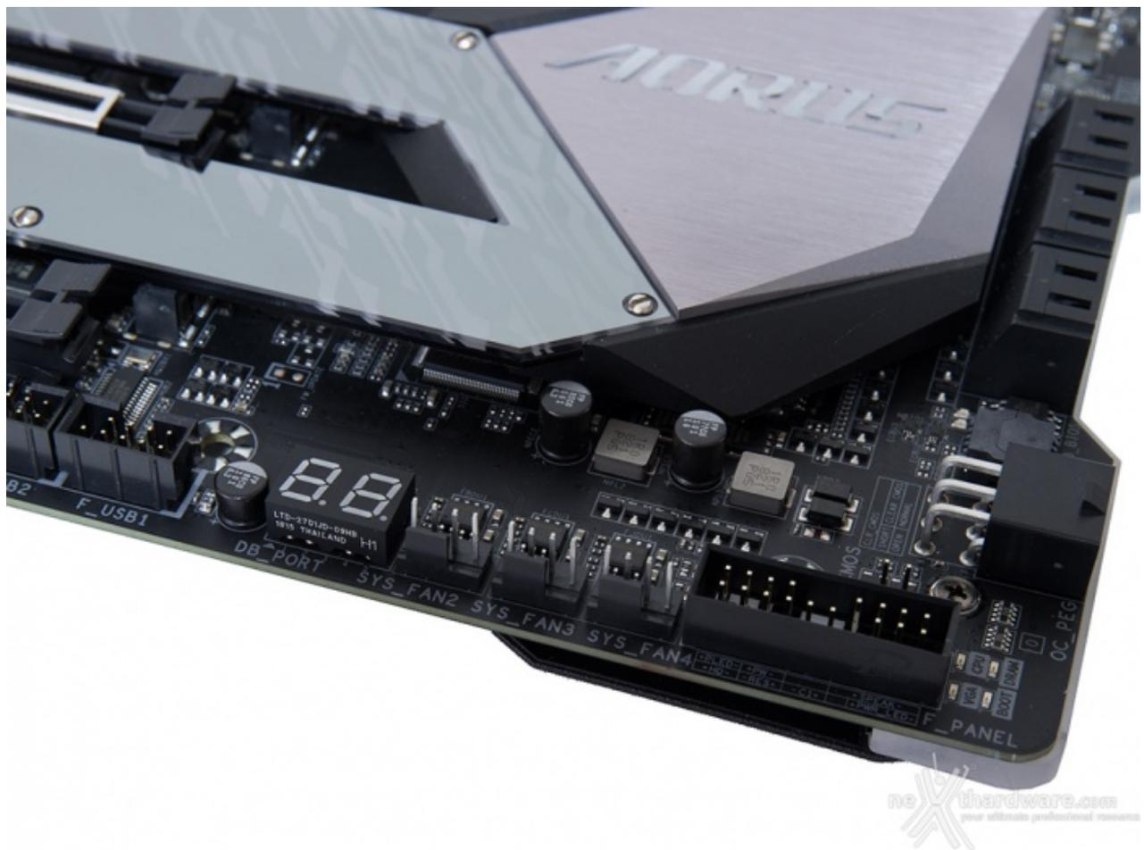
Spostandoci nella zona adiacente il dissipatore del PCH, abbiamo il Debug LED a due cifre che fornisce informazioni riguardo lo stato di boot della macchina mostrando poi, una volta completata questa delicata fase, la temperatura della CPU.
