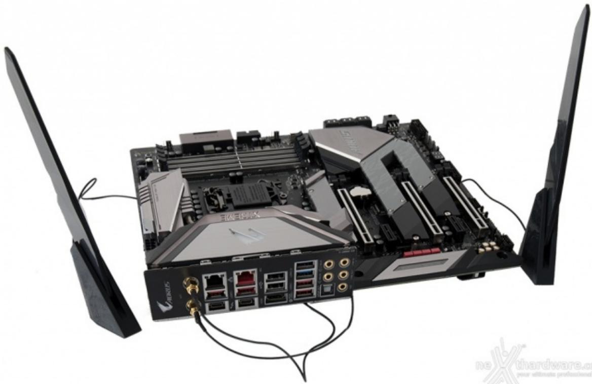
Per massimizzare la resa in game, la scheda in prova implementa un comparto networking di altissimo livello che comprende due porte Gigabit Ethernet e un modulo Intel Wireless 802.11ac Wave 2 (2TR2 & Bluetooth 5.0).
