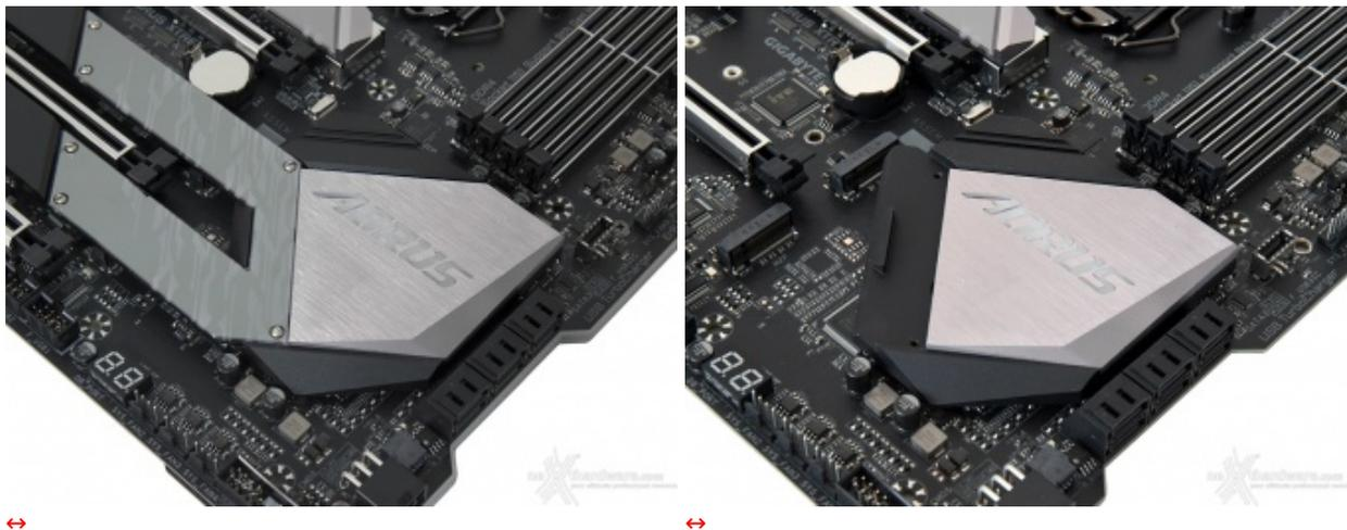
Un terzo dissipatore, di altezza leggermente ridotta, è quello preposto al raffreddamento del PCH Z390, costituito da un un blocco in alluminio pressofuso bicolore con un inserto trasparente avente la forma del logo AORUS, che permette la diffusione dell'illuminazione dai LED RGB sottostanti.
