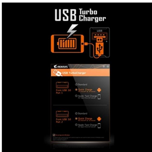
Interessante il fatto che le porte collegate a questo connettore possono beneficiare della tecnologia **GIGABYTE TurboCharger USB** che consente agli utenti di ricaricare i propri dispositivi mobili (Android con QC 3.0 e dispositivi Apple dotati della funzione Apple Fast-Charge) con una velocità sorprendente, fino al 50% in meno di 30 minuti.
