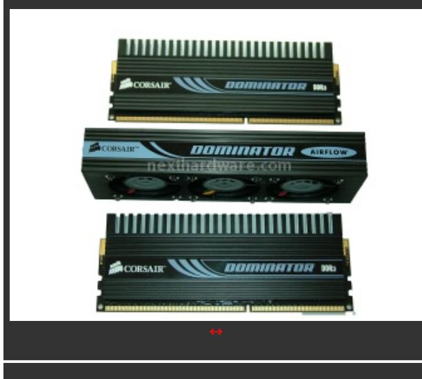
L'airflow consente di posizionare sopra le memorie un unico blocco che contiene tre ventole
