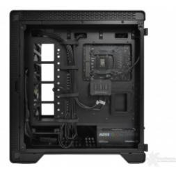
Una volta fissato al suo bezel, l'alimentatore Thermaltake Smart Pro RGB da 850W è stato inserito nel vano a lui dedicato con un ampio margine sulla parte frontale per la disposizione dei cavi.
