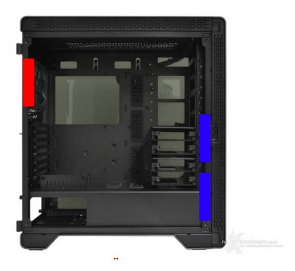
Come dotazione di serie troviamo tre ventole da  $120 \mathrm{mm}$  completamente nere, di cui due posizionate frontalmente e una sul retro.
