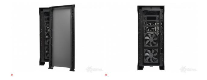
L'intera copertura può essere rimossa facendo leva sulla parte bassa, accedendo così al telaio in acciaio che consente l'installazione di tre ventole da 120 o 140mm, di cui due già previste di serie.
