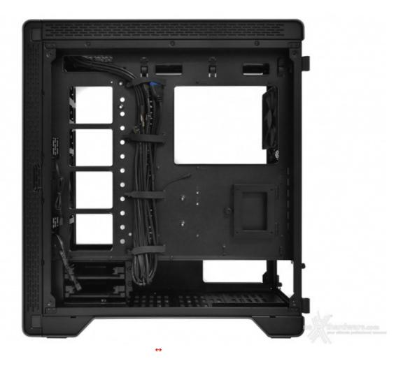
Il cablaggio è affidato a quattro fascette in velcro riutilizzabili posizionate, a nostro avviso, in un punto abbastanza scomodo visto che vanno a coprire completamente le asole passacavo.
