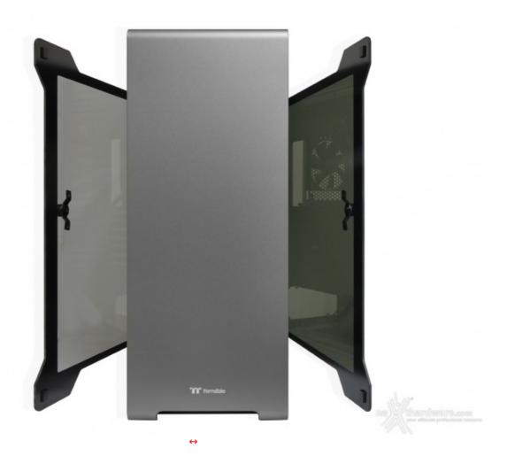
Le due paratie in vetro temperato, spesse ben 4mm, sono fissate al telaio tramite serrature presenti nella parte frontale dove sono anche posizionate delle calamite, dispongono di cardini sul retro per consentire di operare all'interno senza rimuoverle del tutto e sono sagomate ad hoc per non coprire le griglie d'aerazione.
