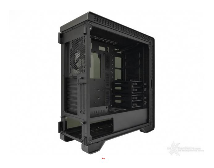
Frontalmente sono fermati due cestelli, contenenti due slitte ciascuno, per il contenimento di drive da 2,5" o 3,5".
