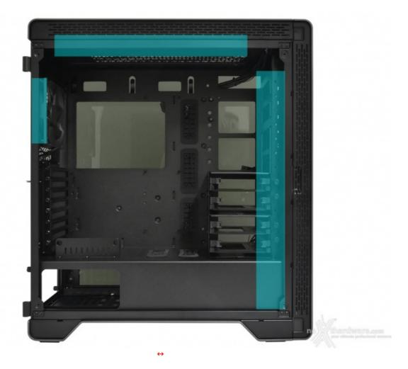
Tutte le predisposizioni possono essere utilizzate per montare radiatori delle medesime dimensioni: sul top ne potrà trovare spazio uno da 360 o 280mm, lungo il frontale, sacrificando i cestelli per drive, uno da 420 o 360mm e, sul retro, uno da 120mm.
