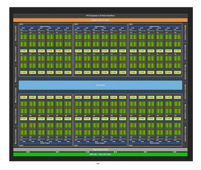
La GPU che equipaggia il modello di punta è denominata TU102 e costituita da ben 18,6 miliardi di transistor su un'area di 754 mm²; numeri decisamente impressionanti se confrontati con quelli della 1080 Ti, ferma a 11,8 miliardi di transistor e 471 mm².
