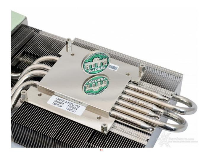
La superficie del dissipatore a contatto con la GPU è frutto della tecnologia ASUS MaxContact, che prevede una base in rame sino a 10 volte più liscia e omogenea del normale per offrire il massimo trasferimento del calore.
