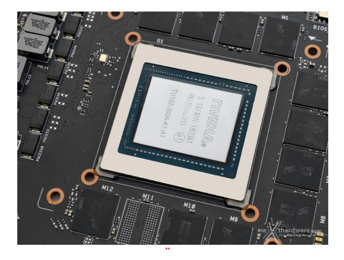
Al centro della scheda troviamo il mastodontico TU102-300A-K1-A1, realizzato da TSMC con processo produttivo a 12nm FinFET e dotato di ben 18,6 miliardi di transistor su una superficie di ben 754mm $\leftrightarrow$ 2.
