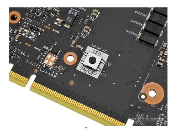
Il retro del PCB della ROG STRIX RTX 2080 Ti OC non mostra componenti di particolare interesse, se non qualche condensatore a montaggio superficiale ed un piccolo attuatore che consentirà la disattivazione hardware del sistema di illuminazione RGB (in foto).
