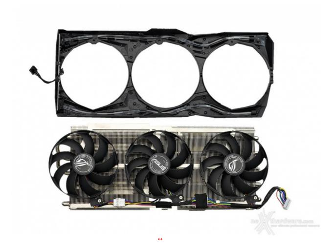
Arriviamo dunque al pezzo forte di questo modello, il sistema di dissipazione DirectCU III, completamente ridisegnato per l'occasione, che integra↔ tre ventole di tipo assiale (Axial Tech).
