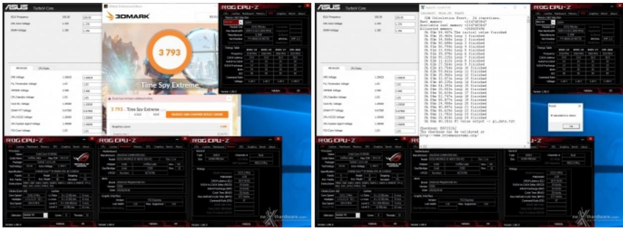
**Test massima frequenza CPU Cache - 4800MHz**
