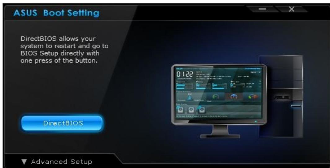
In alternativa, possiamo installare il software **ASUS Boot Setting** che permette di effettuare un riavvio immediato con accesso diretto al BIOS.
