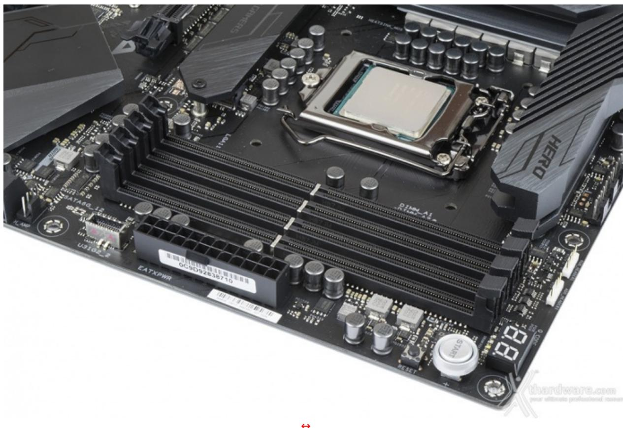
Il comparto dedicato alle memorie presenta quattro slot DIMM di colore nero in grado di ospitare un quantitativo massimo di 64GB di DDR4, ovvero sino a quattro moduli da 16GB l'uno (in modalità dual channel) dotati di profili Intel XMP 2.0 per la configurazione automatica dei relativi parametri di funzionamento.
