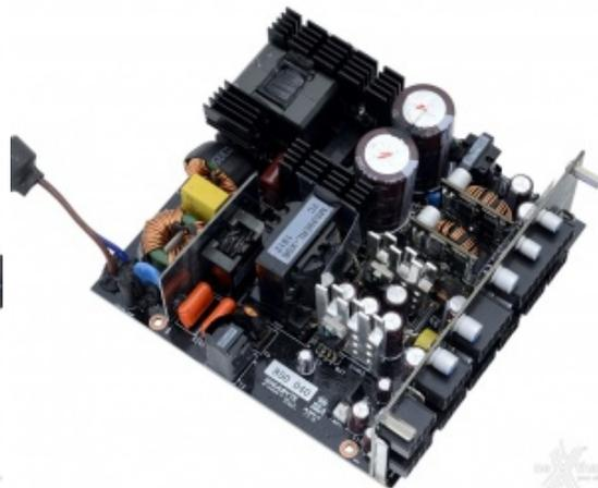
Liberato il PCB dallo chassis, possiamo osservare meglio la disposizione della componentistica: i cinque dissipatori ben visibili in alto si occupano di tenere sotto controllo la temperatura degli elementi più caldi.
