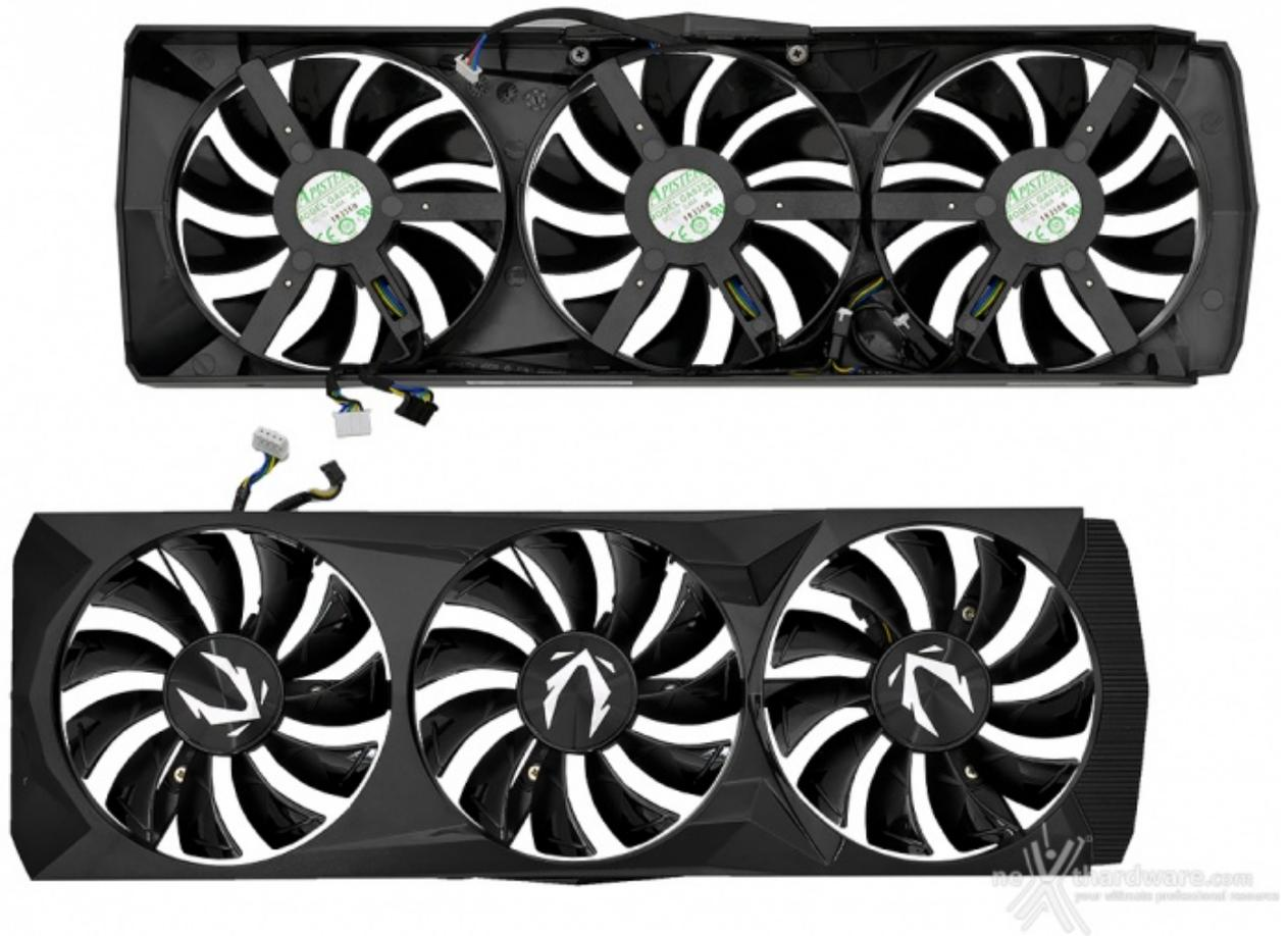
La cover superiore è fermata al dissipatore tramite dieci viti di piccolo taglio per garantire il massimo grado di stabilità e ridurre al minimo le vibrazioni.
