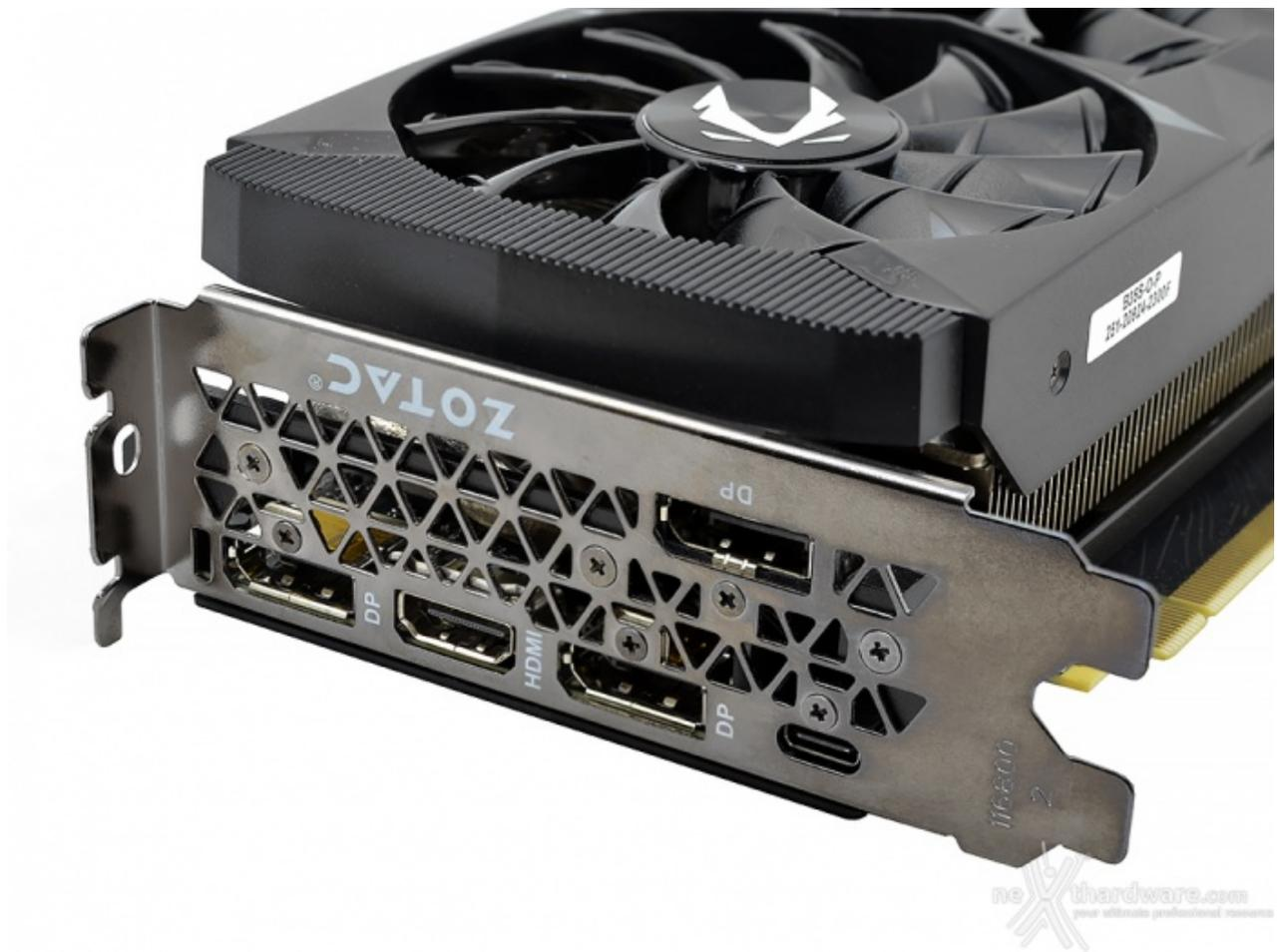
ZOTAC sceglie, infine, di dotare la sua RTX 2080 AMP dello stesso comparto connessioni del modello Founders Edition, esattamente con la medesima disposizione.
