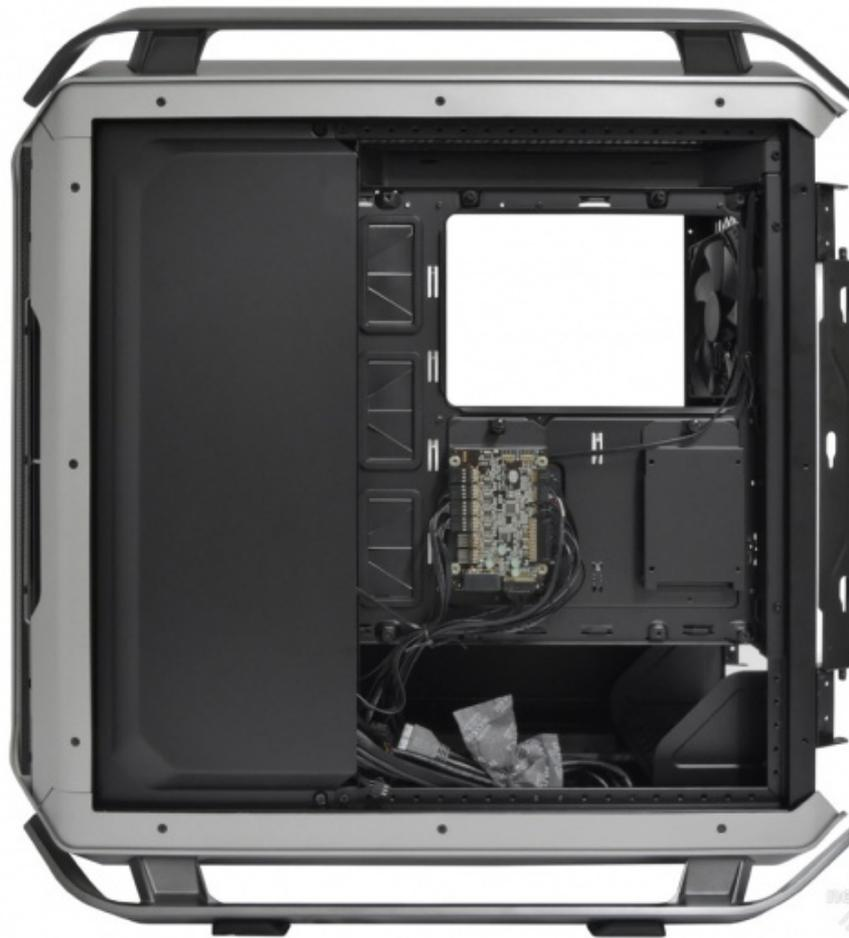
La zona anteriore del piatto mainboard è completamente coperta da un pannello in acciaio fermato al telaio tramite due viti.
