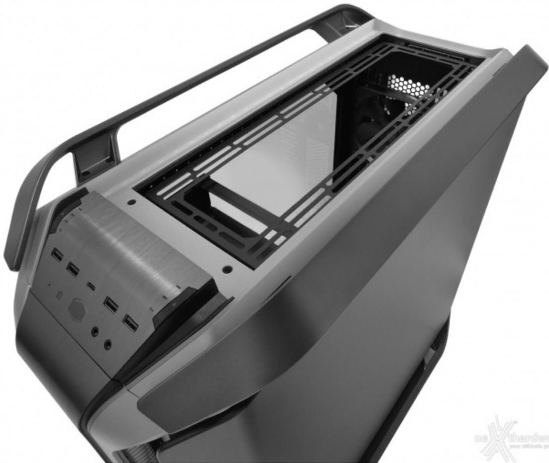
Per facilitare le operazione di installazione di radiatori e ventole, l'intero pannello superiore può essere estratto scoprendo un piccolo telaio, anch'esso removibile, in grado di contenere tre unità da 120 o 140mm.
