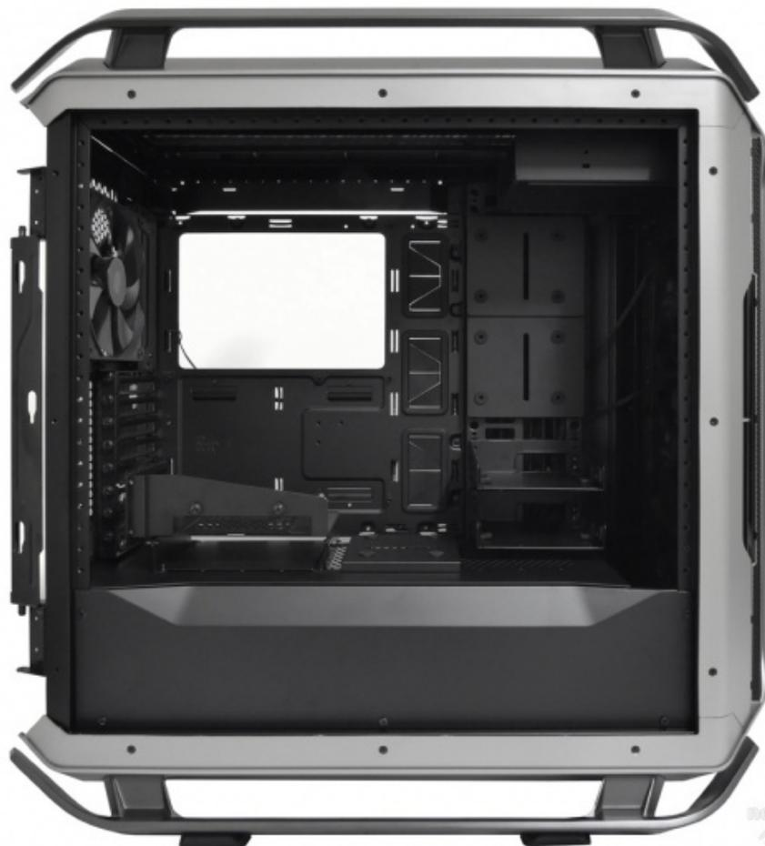
Il piatto mainboard, in grado di contenere schede madri sino al formato E-ATX, è dotato di un ampio scasso per l'installazione e la manutenzione dei sistemi di dissipazione aftermarket (con altezza massima di 198mm) e di tre grandi asole con guarnizioni in gomma per il passaggio dei cavi.
