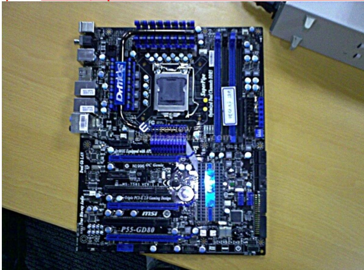
Tra le varie features della **P55.GD80** troviamo tre connettori PCI-E 16x, quattro slot di memoria capaci di supportare fino a **16GB** di RAM di tipo **DDR3** in modalità dual-channel e due schede di rete **Gigabit LAN**; inoltre la scheda dovrebbe essere in grado di supportare le tecnologie **SLI** e **CrossFire**. Al momento non sono disponibili data e prezzo di lancio.
