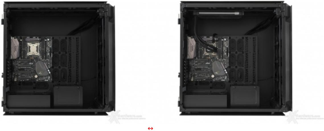
Per prima cosa, come sempre, abbiamo provveduto ad installare la mainboard e, successivamente, il sistema di raffreddamento a liquido compatto privo delle sue ventole standard.
