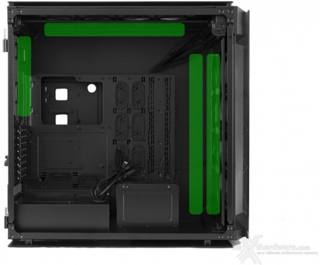
Tutte le predisposizioni sono utilizzabili per il montaggio di un impianto a liquido AiO o custom, con la possibilità di installare contemporaneamente due radiatori da 480mm sul frontale, uno da 420mm sul top ed uno da 240mm sul posteriore, superando di gran lunga la potenzialità dell'Obsidian 900D e candidandosi a diventare il nuovo punto di riferimento per gli amanti del watercooling.
