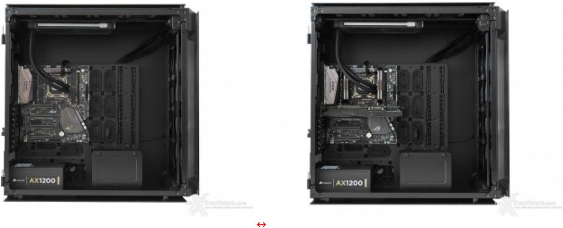
A questo punto abbiamo rimosso il carter di protezione del vano alimentatore per procedere al montaggio del nostro AX1200, a cui ha fatto seguito l'installazione delle memorie, della scheda video e del CORSAIR MP 500.
