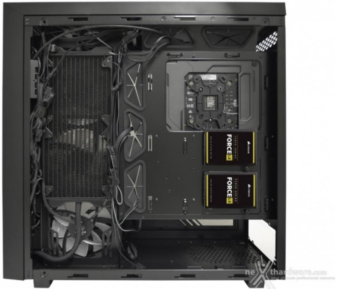
Una volta completata l'installazione della scheda madre e dei componenti ad essa fisicamente collegati, ci siamo dedicati al fissaggio dei due drive da 2,5" rimuovendo la paratia destra. Questi ultimi sono stati posizionati sul retro della struttura in modo da poter essere sostituiti velocemente in caso di necessità .
