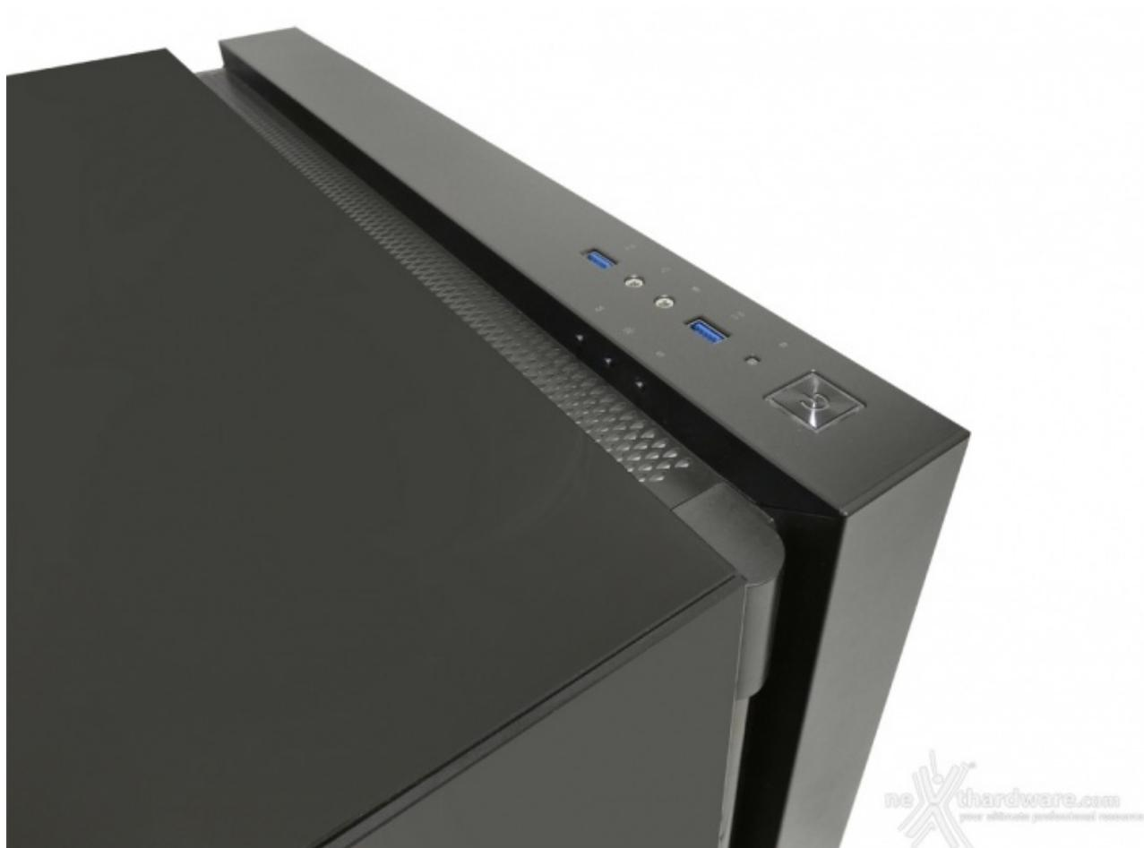
Nella parte anteriore della zona in plastica è posizionato il pannello I/O composto da due USB 3.0, due jack HD Audio, il LED di stato ed il tasto di accensione.
