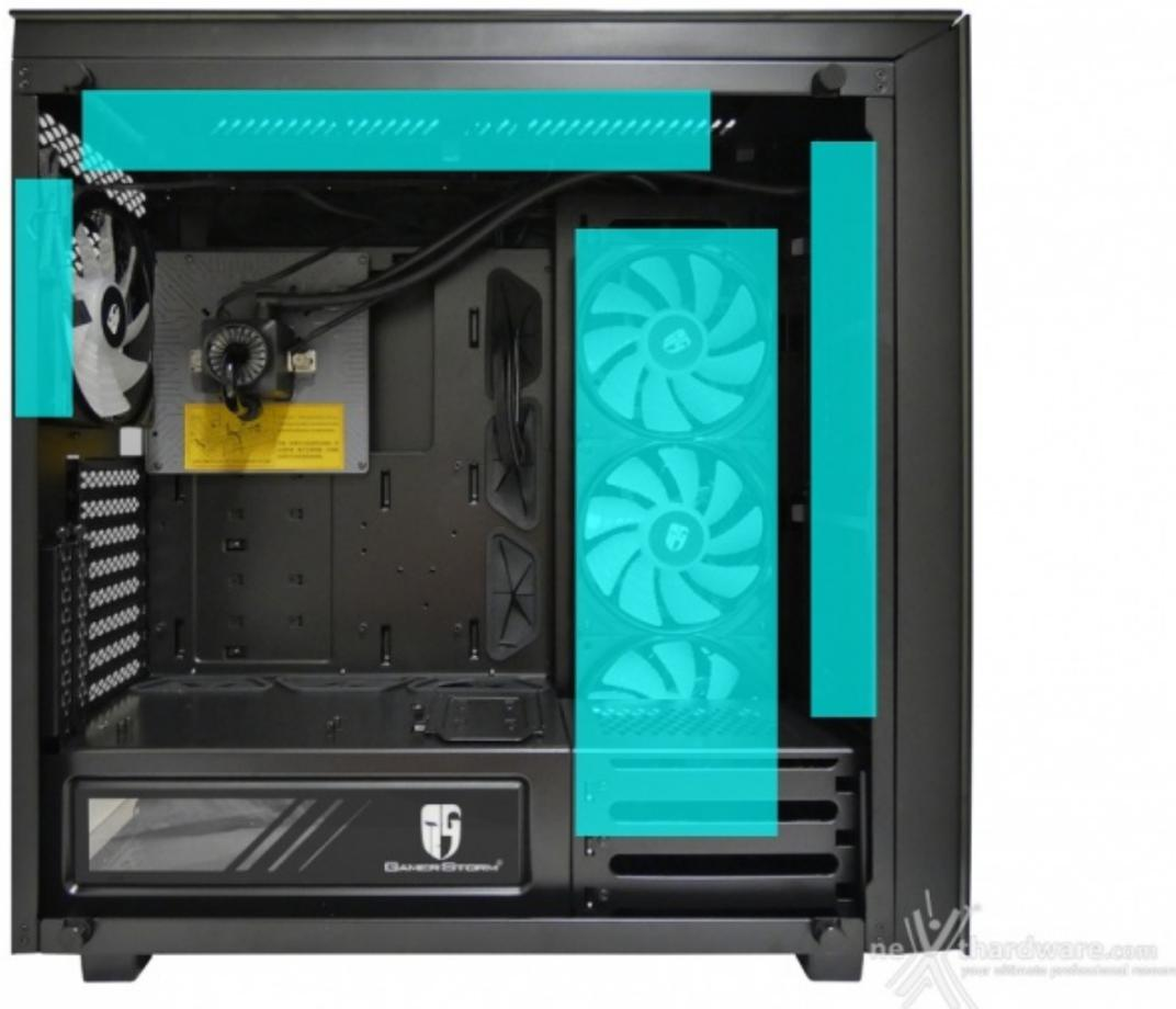
Nonostante l'elevato potenziale di base, il sistema a liquido potrà essere potenziato con un radiatore da 360 o da 420mm al posto di quello da 280mm lateralmente, uno da 140mm sul retro ed uno da 360mm sul top.
