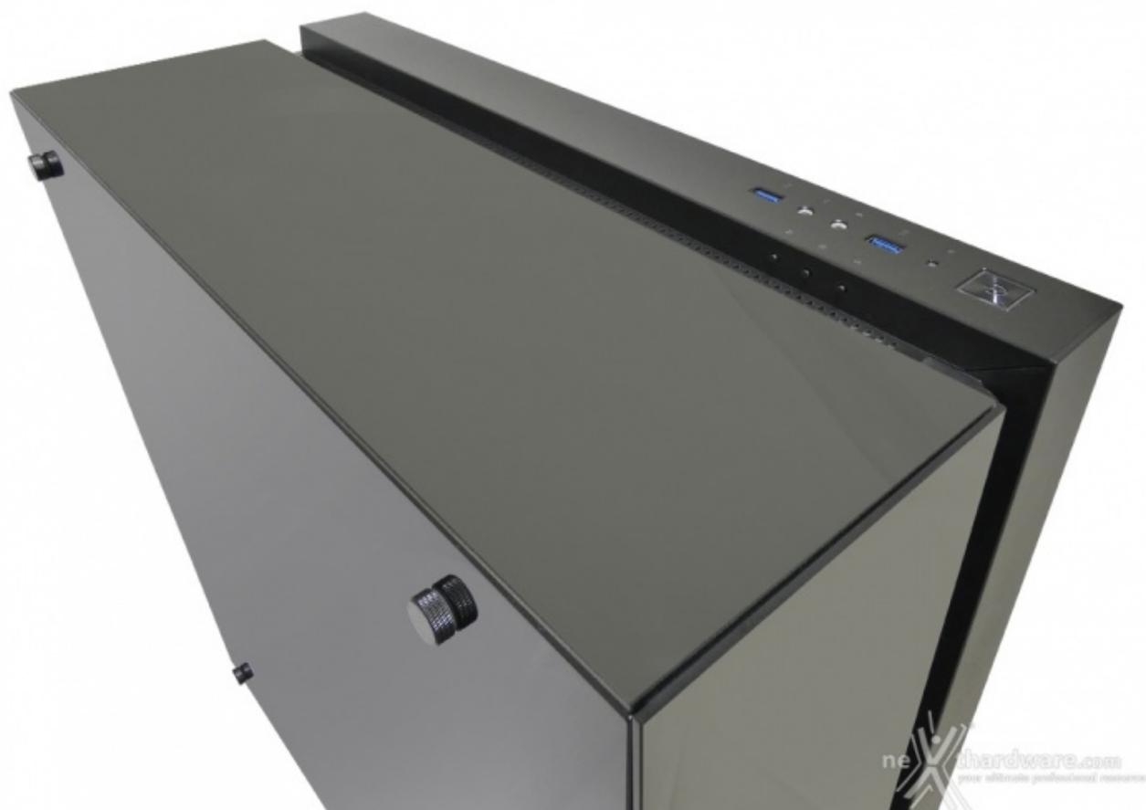
Il top riprende le linee del frontale ma, in questo caso, a fare da divisorio tra la zona in vetro e quella in plastica, vi è un canale che presenta dei fori per il passaggio dell'aria lungo i lati ed una ulteriore striscia a LED RGB.
