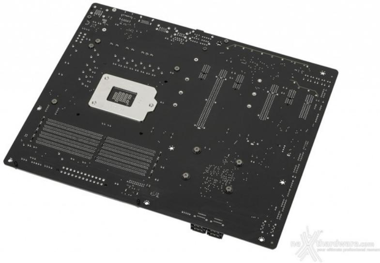
Sul retro del PCB, di colore rigorosamente nero, possiamo osservare il robusto backplate in metallo del socket e le viti di ritenzione dei dissipatori presenti sul lato opposto.
