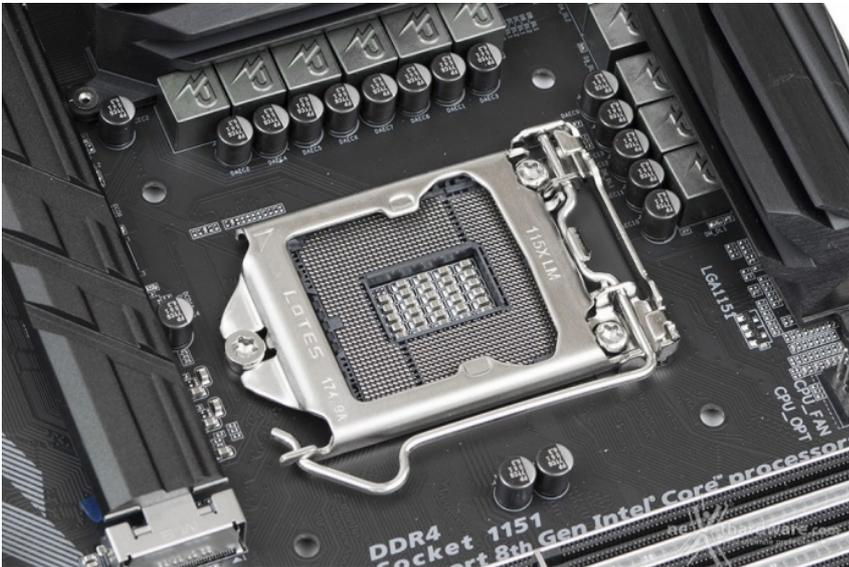
Il socket utilizzato è il nuovo LGA 1151 V2 in grado di garantire il pieno supporto alle CPU Intel Coffee Lake, ma purtroppo incompatibile dal punto di vista elettrico con i processori di precedente generazione.
