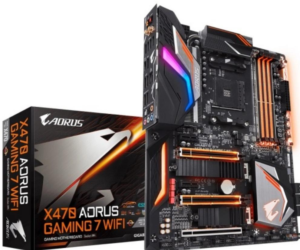
Come se non bastasse, questa delicata zona della scheda madre presenta su tutti i modelli una dissipazione del calore maggiorata del 300% grazie all'utilizzo della tecnologia Fins-Array che prevede l'adozione di un fitto corpo di alette in alluminio e heatpipes a diretto contatto con i componenti da
