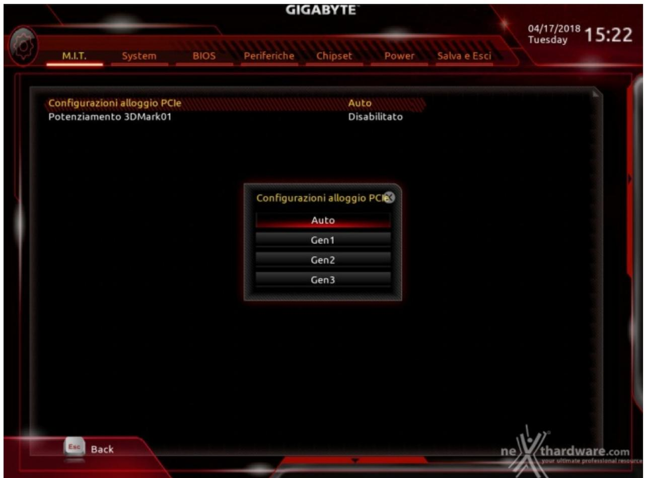
Qui è possibile forzare il funzionamento degli slot PCIe ad una velocità ridotta per aumentare la compatibilità con VGA o altre schede più datate e abilitare o meno il tweak per migliorare i punteggi sul 3DMark01.
