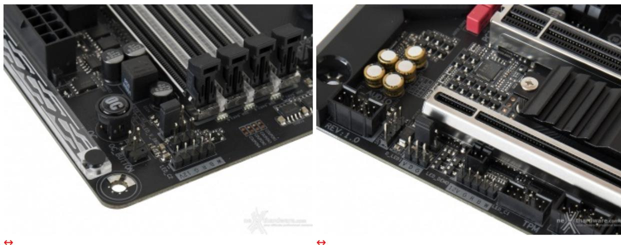
Le immagini ci mostrano la collocazione dei quattro connettori posizionati, rispettivamente, i primi due nell'angolo destro della mainboard e gli altri due sul bordo sinistro in posizione antistante l'ultimo slot PCIe.
