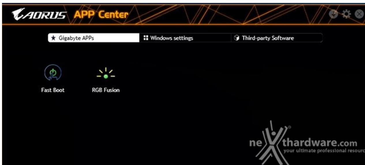
In alternativa possiamo installare l'utility Fast Boot facente parte della suite GIGABYTE App Center, che permette di effettuare un riavvio immediato con accesso diretto al BIOS.
