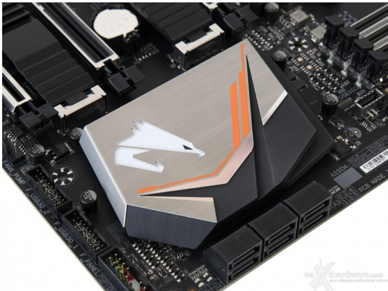
Un terzo dissipatore, di altezza leggermente ridotta, è quello preposto al raffreddamento del chipset AMD X470.
