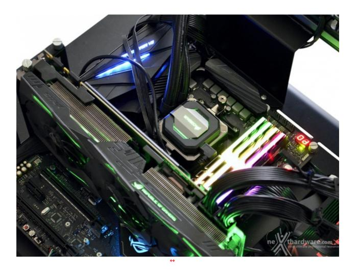
Per il raffreddamento del processore ci siamo affidati ad un sistema a liquido compatto come il CORSAIR H110i che, pur non avendo le prestazioni di un impianto custom di tipo professionale, è in grado di svolgere in maniera egregia il suo lavoro permettendo di verificare l'efficienza della piattaforma in prova nella gestione di overclock replicabili dalla maggior parte degli utenti.
