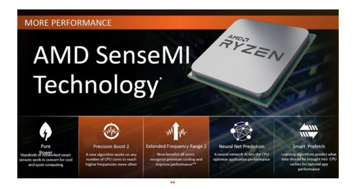
I nuovi processori Ryzen utilizzano una griglia di sensori, tutti interconnessi tra loro, in grado di misurare le grandezze d'interesse con una precisione di 1mA, 1mV, 1mW e  $1 \leftrightarrow ^{\circ}C$ , rispettivamente, per corrente, tensione, potenza e temperatura con una frequenza di rilevazione di 1kHz, ossia 1000 letture al secondo.
