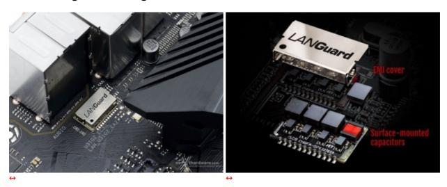
Il sistema LANGuard utilizza un raffinato sistema di accoppiatori e condensatori a montaggio superficiale racchiusi in un unico componente al fine di proteggere la scheda di rete da eventuali scariche.
