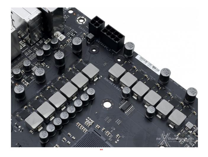
Il circuito di alimentazione della CPU è costituito da un totale 12 fasi realizzate mediante l'impiego di regolatori DrMOS prodotti da International Rectifier (acquisita di recente da Infineon); in uscita ad ognuna delle fasi troviamo un induttore ed un condensatore allo stato solido.
