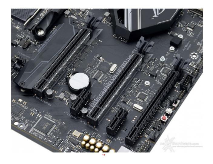
La dotazione di slot PCI-E è stata invece ridotta di un connettore X1 per lasciar posto, nella parte alta, allo slot M.2 dotato di dissipatore.
