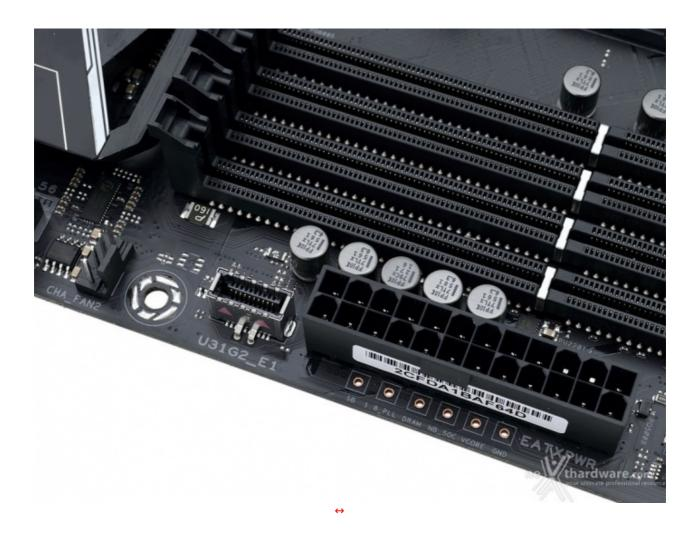
La CROSSHAIR VII HERO (Wi-Fi) mette a disposizione una seconda porta USB Type-C tramite un header interno ubicato in prossimità del connettore ATX.
