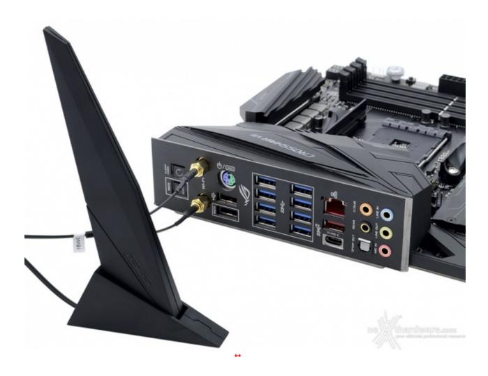
Il modulo radio integrato sulla CROSSHAIR VII HERO (Wi-Fi) ha al suo interno sia la scheda di rete Wireless Dual Band (2,4 e 5GHz) che un ricevitore Bluetooth in versione 4.2.
