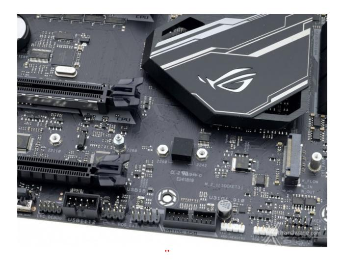
Il secondo slot M.2 posizionato sotto il chipset non dispone di un dissipatore integrato, ma consente l'installazione di moduli di maggior dimensione fino al formato 22110 (110 mm), oltre ad essere compatibile sia con dispositivi PCI-E che SATA.
