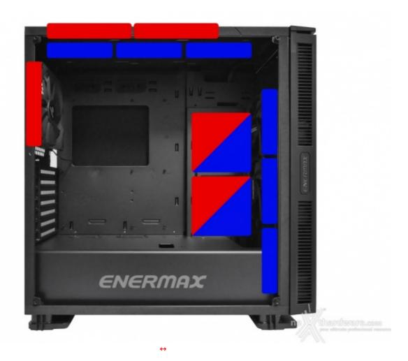
Sul frontale è possibile aggiungere una terza ventola da 120mm, a destra del piatto mainboard possono trovar spazio altre due delle medesime dimensioni e, infine, sul top è possibile utilizzarne tre da 120mm o due da 140mm.
