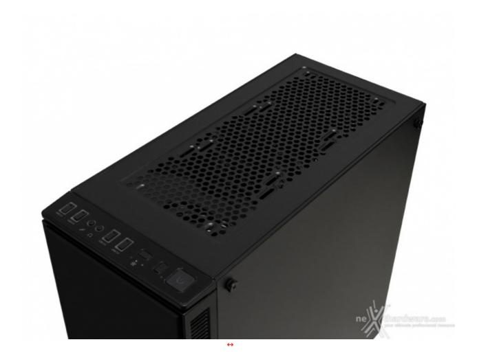
Rimuovendolo è possibile accedere alla griglia che consente l'installazione di tre ventole da 120mm o due da 140mm.
