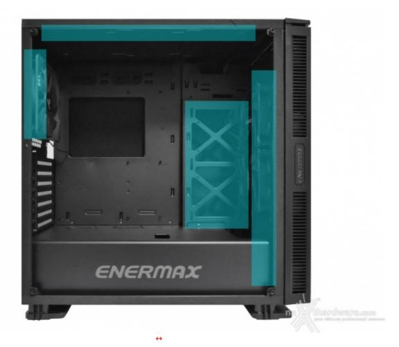
Posteriormente potrà essere montato un radiatore da 120 o 140mm, sul top uno da 280 o 360mm, frontalmente uno da 360mm e, a destra del piatto mainboard, uno da 240mm a patto che non si utilizzi una scheda video particolarmente lunga.
