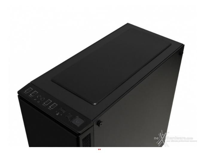
La restante parte del top è coperta da un pannello in plastica rivestito, internamente, da materiale fonoassorbente e fermato al telaio attraverso delle calamite.
