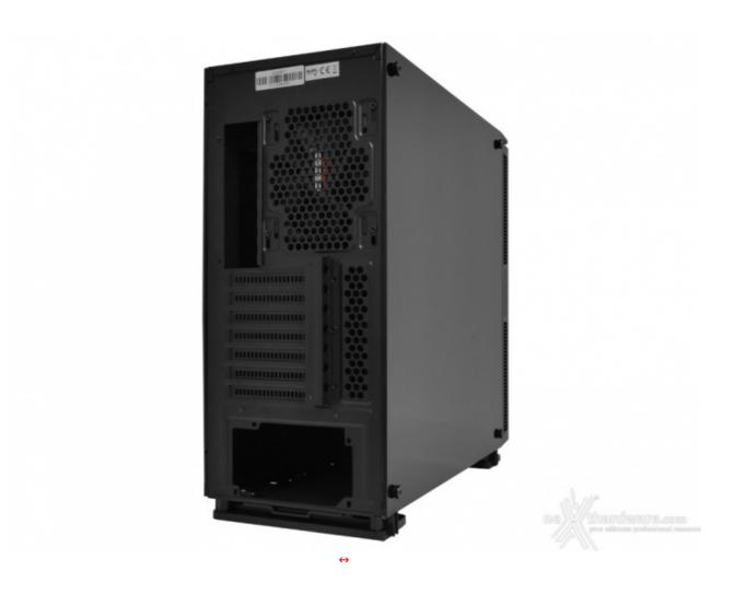
Il retro del case ha una disposizione standard e vede la presenza di un foro per l'I/O shield affiancato da una predisposizione per ventola da 120mm o 140mm (inclusa) leggermente traslabile in altezza.
