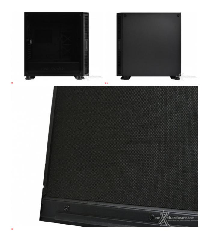
I pannelli laterali sono di ottima qualità : quello di sinistra è in vetro temperato spesso 4mm con finitura fumè ed è fermato al telaio attraverso quattro viti zigrinate, mentre quello di destra, fermato da due sole viti, è in robusto acciaio con rivestimento interno in materiale fonoassorbente.
