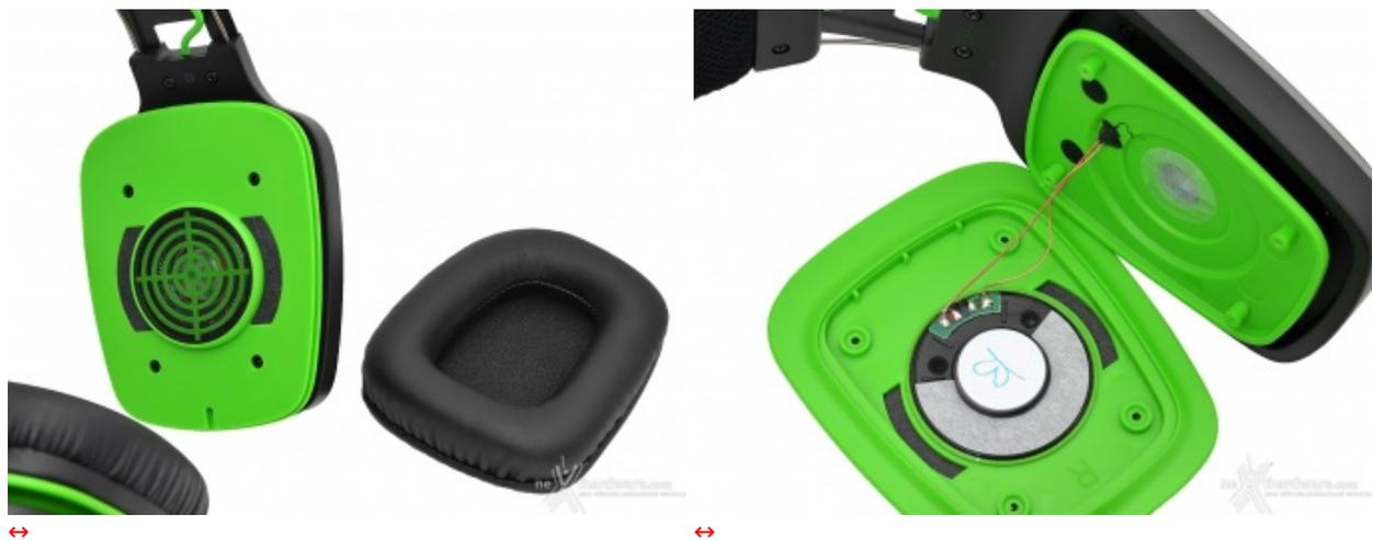
L'elettronica è protetta da una sottile copertura in plastica rigida serrata agli angoli da quattro viti,
