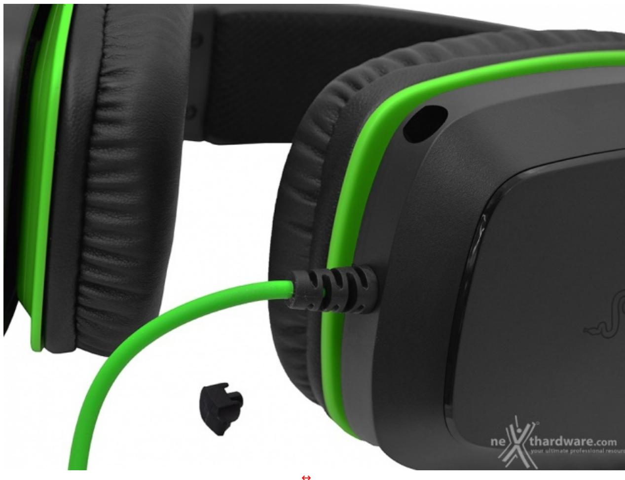
Coperto da un cappuccio in gomma, posizionato sempre sul padiglione di sinistra, è situato l'alloggiamento con ingresso jack da 3,5mm per il microfono fornito a corredo.
