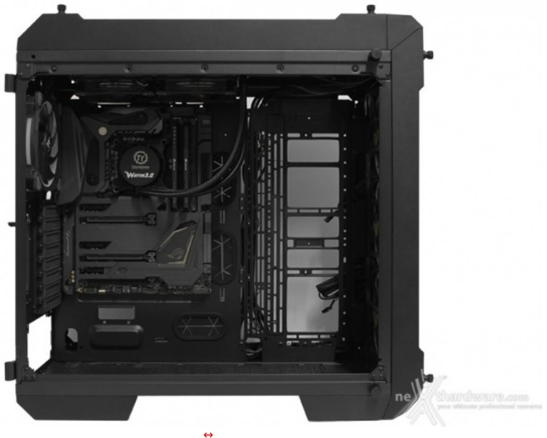
Ricordiamo che, qualora non si volesse utilizzare un sistema di raffreddamento a liquido, il case è in grado di contenere dissipatori ad aria per CPU alti ben 190mm.
