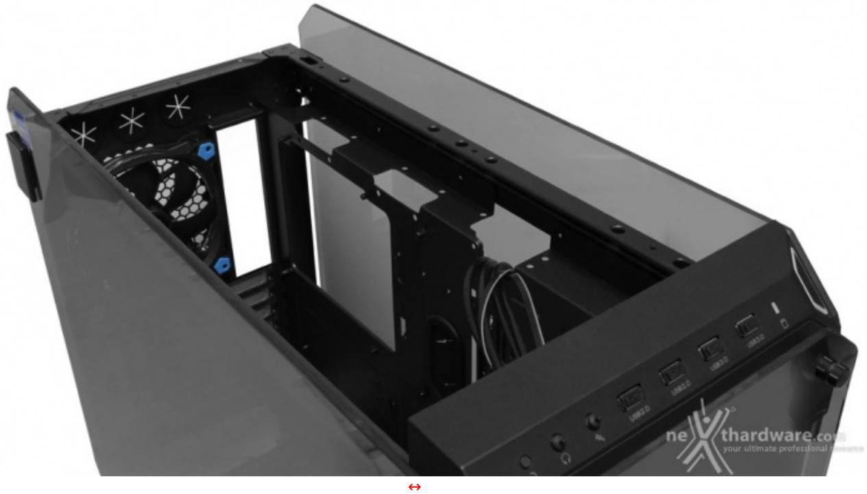
Detto telaio, che funge da supporto per tre ventole da 120 o 140mm, può essere spostato centralmente o lateralmente, in base alle proprie esigenze, consentendo di utilizzare radiatori di generose dimensioni anche in presenza di schede madri dotate di sistemi di dissipazioni per le fasi d'alimentazione particolarmente ingombranti e RAM ad alto profilo.
