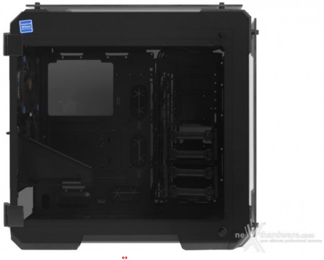
Entrambi i pannelli laterali sono realizzati in vetro temperato spesso 5mm e dispongono di due cardini che ne permettono l'apertura rimuovendo solo due viti zigrinate.
