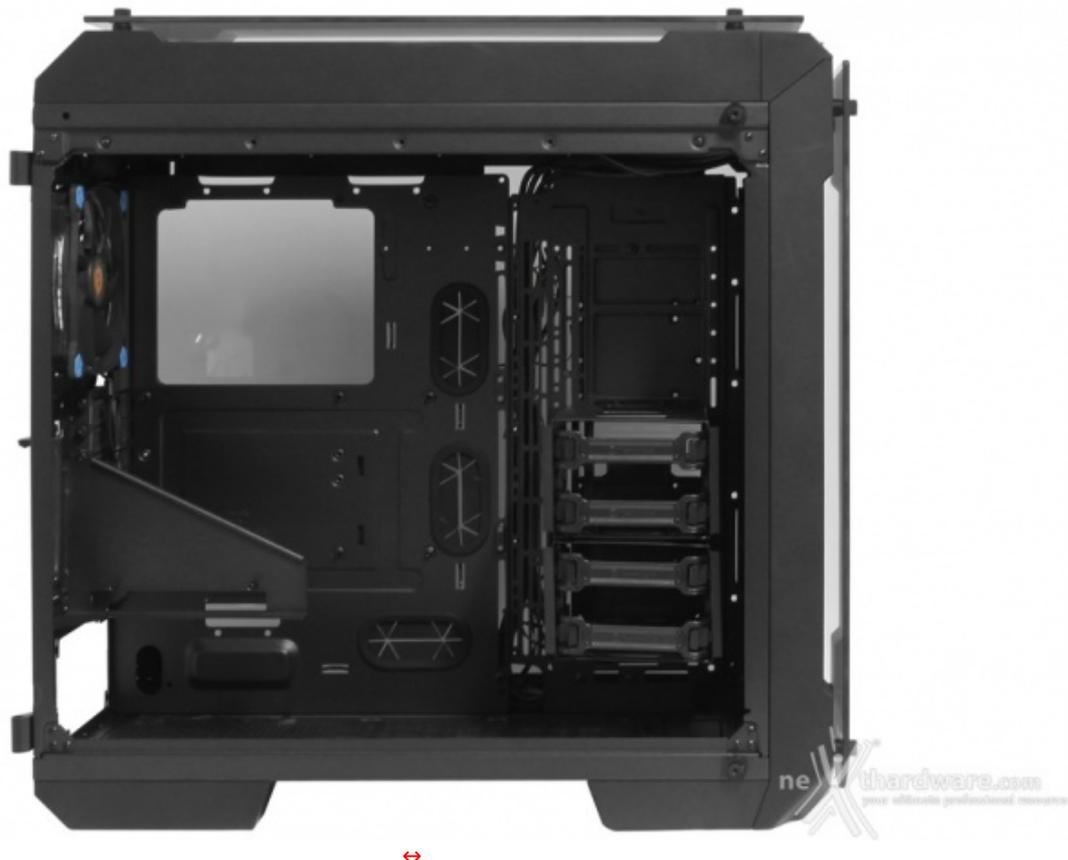
L'interno del Thermaltake View 71 TG è completamente verniciato di nero ed in modo impeccabile; tutti i cavi dispongono inoltre di guaina dello stesso colore per risultare meno visibili.
