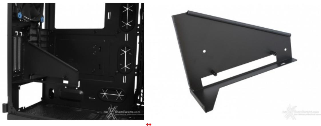
Sul retro, di fianco ai canonici slot PCI, è fermato al telaio, tramite viti zigrinate, un supporto che permette l'installazione di una scheda video dual slot parallelamente alla scheda madre, a patto di procurarsi una Riser Card PCI-E non presente in bundle.
