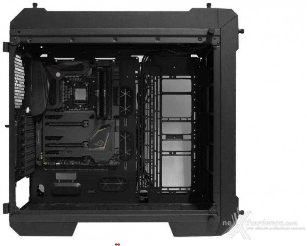
Per prima cosa, data l'assenza di una Riser Card PCI-E, abbiamo rimosso il supporto che consente l'utilizzo di schede video in verticale ed abbiamo subito montato la scheda madre.
